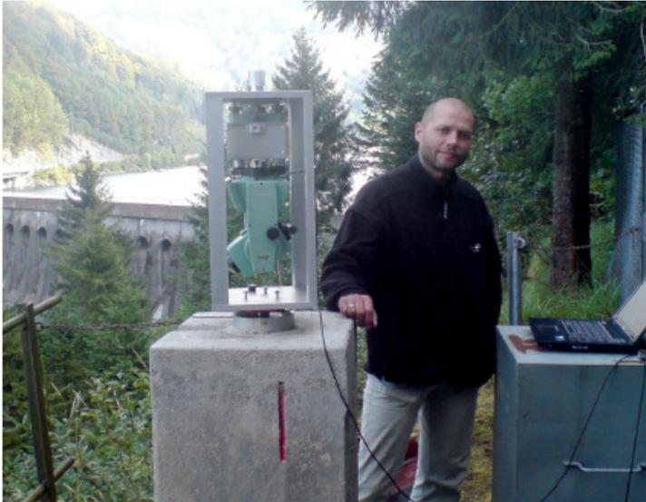
Abb. 7: Hängetachymeter im Zentrierrahmen
