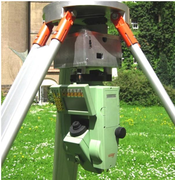
Abb. 2: Hängetachymeter in Messposition
