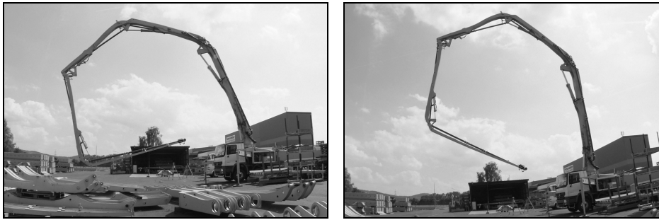
Abb. 4: Unterschiedliche Armstellung bei gleichem Verfahradius
