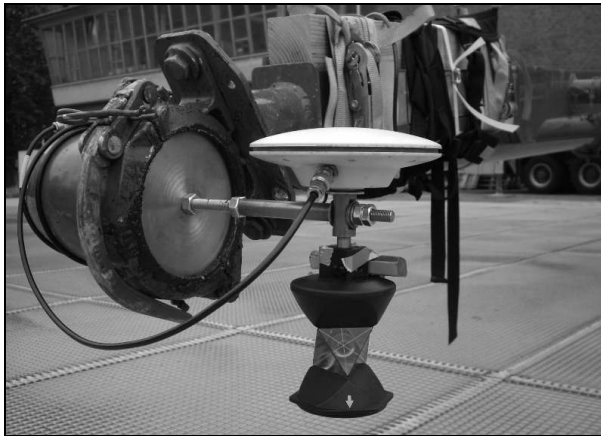
Abb. 10: Sensorhalterung an der Mastspitze (pendelnd gelagert)
