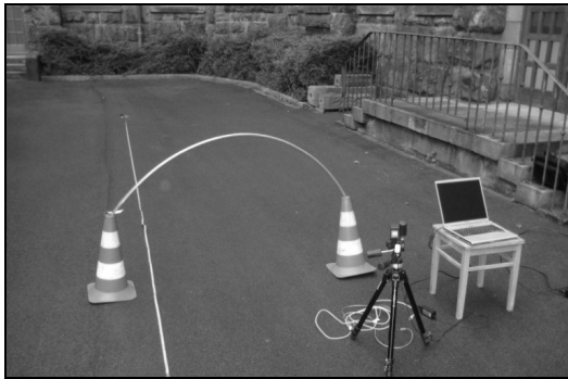
Abb. 13: Aufbau zum Test der SwissRanger 3000
