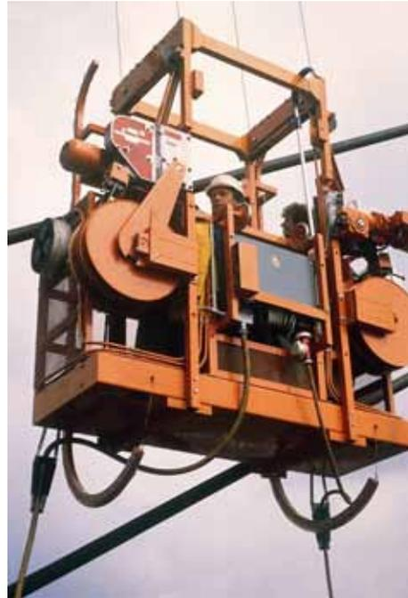
**Bild 2.4:** Brückenseilbesichtigungsgerät im Einsatz
