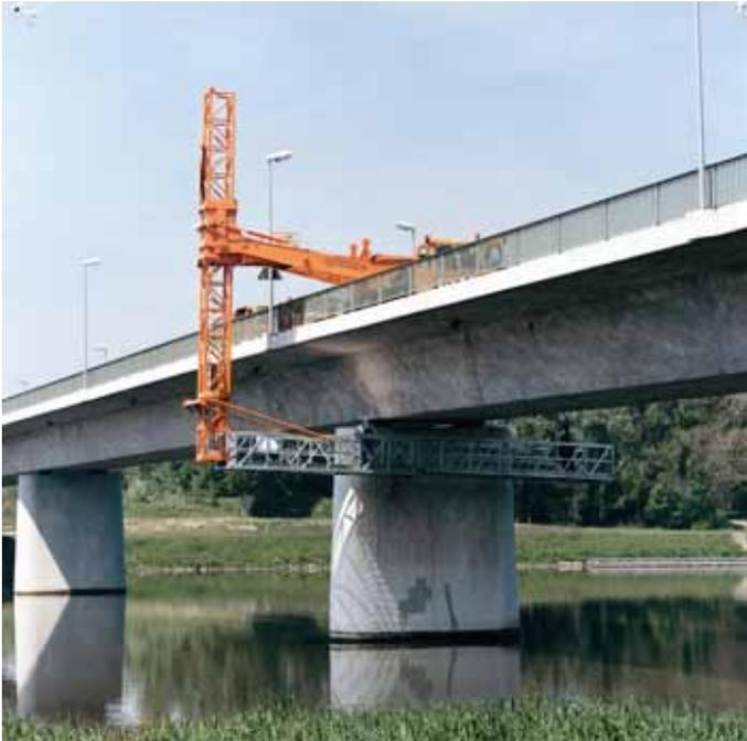
**Bild 2.3:** Unterflurbesichtigungsgerät
