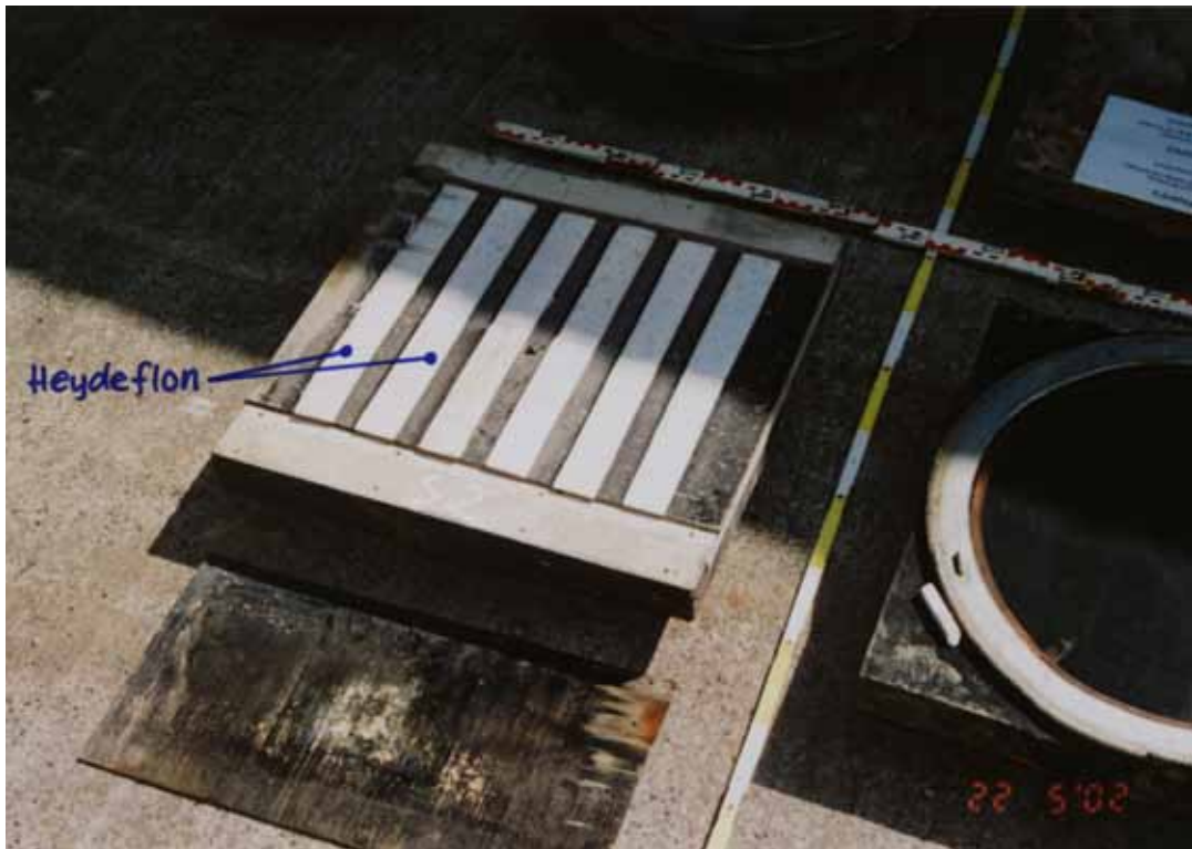
Bild 9.22: Proben von Stützenreihe 1 und 2, Gleitlager, innen praktisch guter bis sehr guter Zustand
