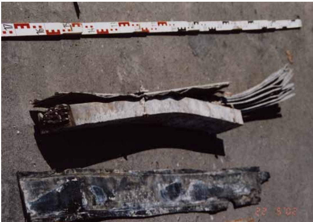
Bild 9.15: Spanngliedführung am Wendepunkt in U-Profil mit Blechabdeckung
