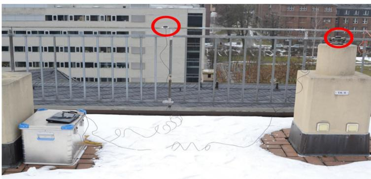
Abb. 2: Messaufbau auf dem Beyer-Bau der TU Dresden (rotmarkiert: u-blox Antennen)
