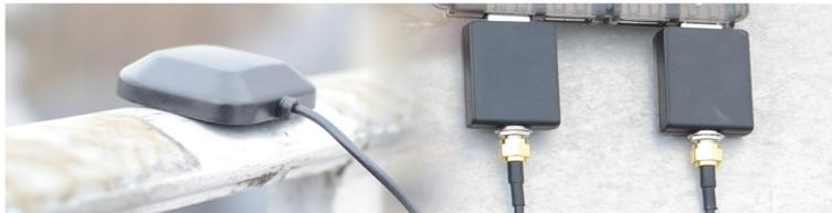
Abb. 1: Antenne (links), u-blox NEO 6P (rechts)
