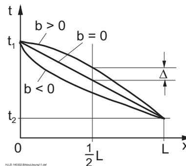
Bei einer Wärmesenke ( $b < 0$ ) ist der Verlauf nach unten gekrümmt und die größten Wärmestromdichten treten an der linken Wandseite auf.  $|\Delta|$  liefert den Beitrag der partikulären Lösung. Das Betragsmaximum ergibt sich bei  $x = 0,5 L$  zu
