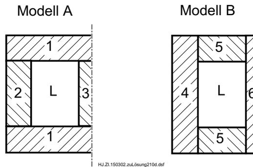
Modell A: Es wird angenommen, daß in der Schicht 1 eine einheitliche Temperatur in Querrichtung vorliegt. Das bedeutet, daß für den Wärmetransport in Querrichtung kein Widerstand auftritt (unendlich große Wärmeleitfähigkeit).
