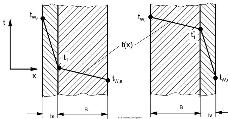
Mit  $\hat{q} = \frac{\dot{Q}}{A}$ ,  $\dot{Q} = \frac{\Delta t}{R_\lambda}$  und dem Wärmeleitwiderstand  $R_\lambda = \frac{\delta}{\lambda A}$  gilt analog dem Ohmschen Gesetz für die gesamte Wand (Reihenschaltung) bzw. die linke Wandschicht
