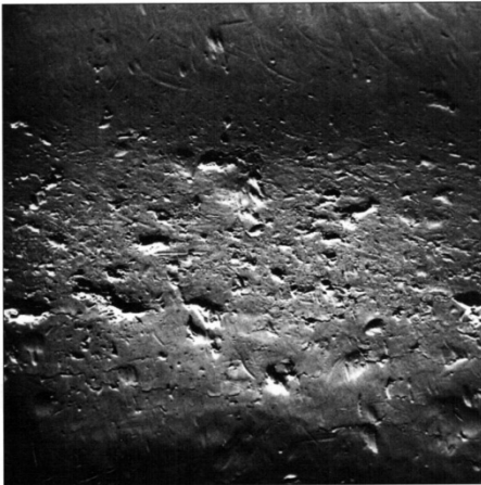
Bild 258: Übersicht zu den Bildern 259–261. Am Fuß einer Zahnflanke des treibenden Rades trat in einem Streifen durch Überbeanspruchung des Wälzkreises Pittingbildung auf. Die Pittings entstehen durch plastisches Verschieben von Zungen (im Bild von oben nach unten), schieferartige Unterteilung der Zungen durch Gleitpakete und Scherrisse, Ausbreitung von Schwingbrüchen ins Werkstoffinnere und schließlich gewaltsames Abreißen der Zungen. 45:1
