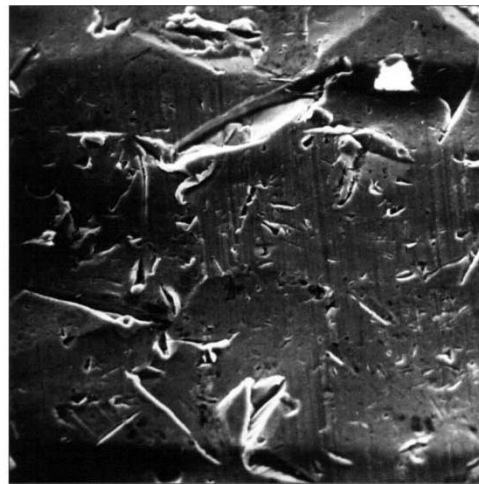
Bild 300: Kugelgestrahlte Aluminium- fläche mit Einschlägen von zersplit- terten alten Glaskugeln. Oben rechts im Bild leuchtet infolge Aufladung ein Glossplitter auf. 1000:1
