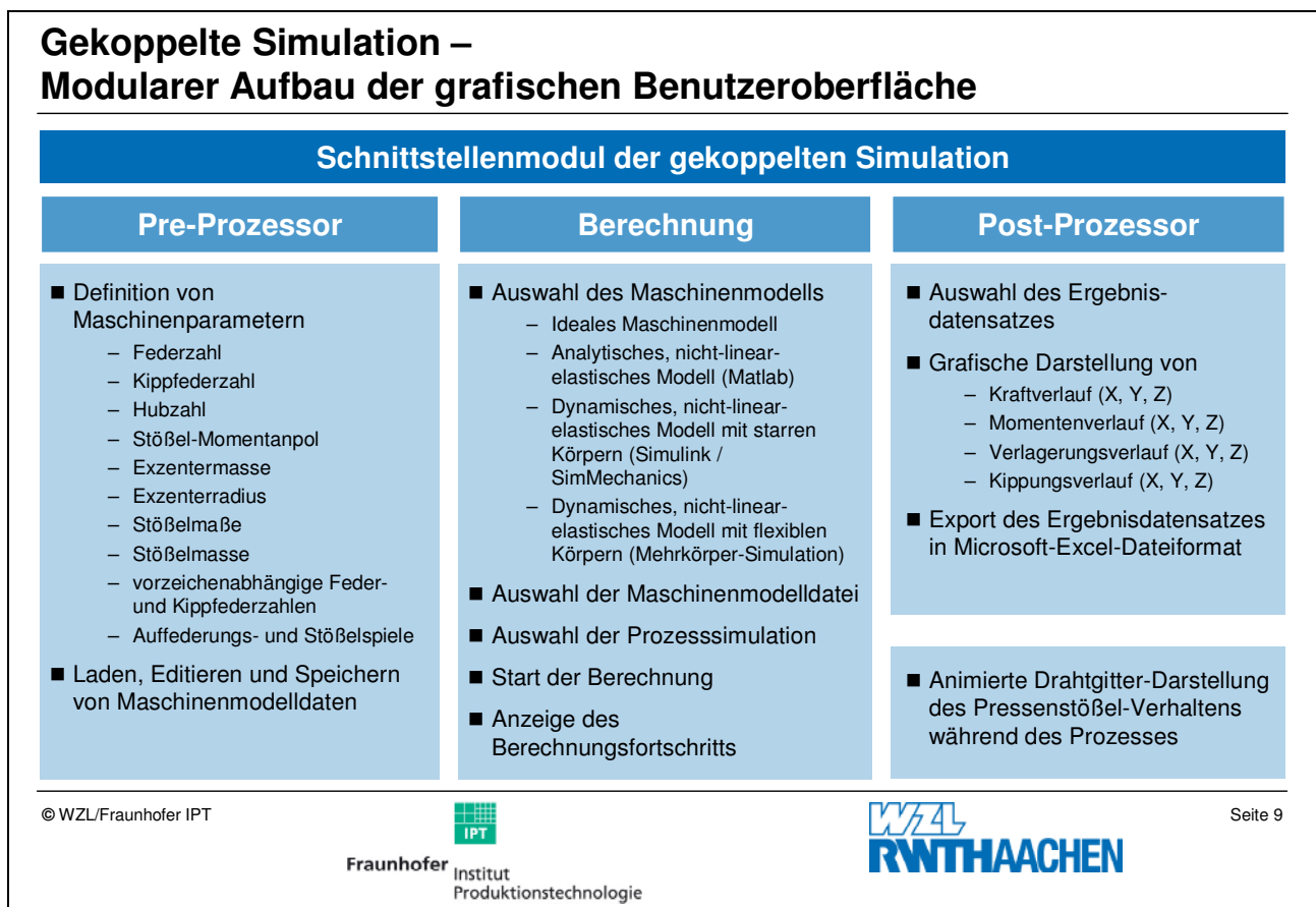
Bild 6: Modularer Aufbau der grafischen Oberfläche der gekoppelten Simulation
