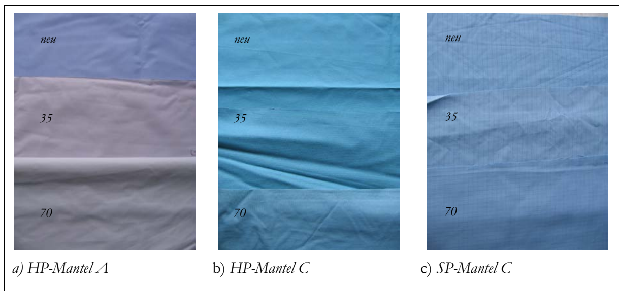
Abbildung 4-1: Erscheinungsbild der Textilkonstruktionen in den wundnahen Bereichen im Neuzustand sowie nach 35 und 70 Nutzungszyklen
