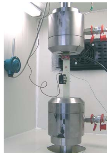
Abb. 4: Dynamische Untersuchung eines Zwischenfaserbruchs
