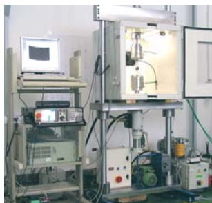
Abb. 1: Servohydraulische Prüfmaschine zur Untersuchung dynamisch bedingter Zwischenfaserbrüche
