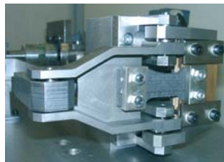
Abb 2: Einzelprüfstelle der Mehrfach-Anlage für Dauerschwingversuche nach DIN 53442
