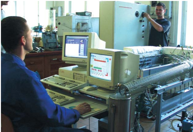
Bild 1: Versuchsstand zur anwendungsnahe Untersuchung von Katalysatoren für das Erdgasreforming
