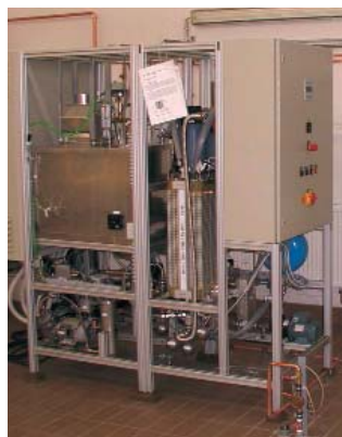
Bild 3: Brennstoffzellen-Mini-BHKW, Feldtestanlage Stadtwerke Riesa GmbH
