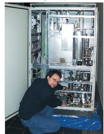
Bild 2: Erdgasreformer für 6 m 3 /h Reformat (75% H 2 , < 10 ppm CO)
