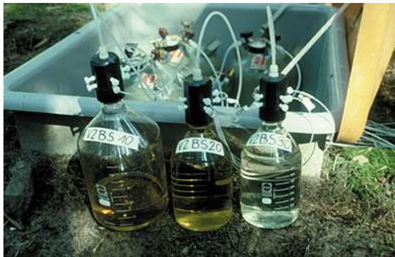
Gewinnung von Bodensickerwasser durch ein Unterdruck-Pumpensystem
