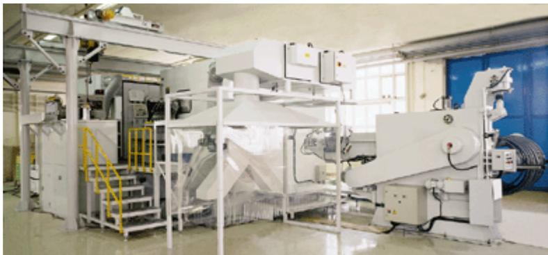
Die moderne Horizontalpresse ermöglicht die Bolzenherstellung direkt vom endlos zugeführten Draht
