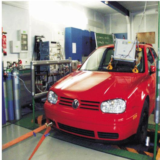
Erprobung neuer Diagnoseverfahren auf dem Leistungsrollenprüfstand
