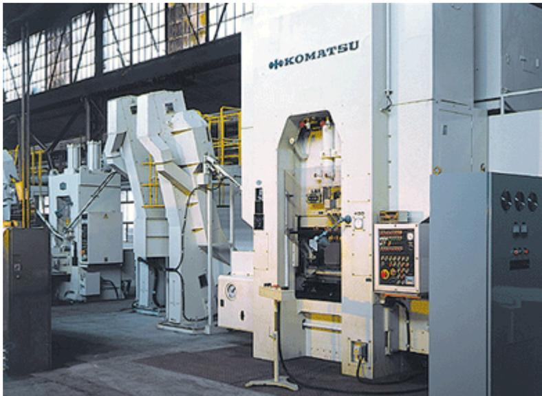
Mehrstuftenpressen zur Fertigung von Fließpressteilen durch Verformung
