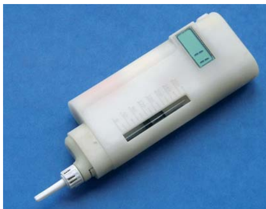
Abb. 2: Funktionsmuster des automatischen Injektionsgerätes in der Größe eines Mobiltelefons mit eingelegter Ampulle und aufgesteckter Pennadel (mit Schutzkappe) Foto: IFTE
