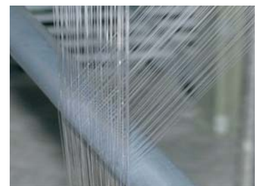
Abb. 2 Oben: Düsenwanne zum Erspinnen von Glasfilamentgarnen
