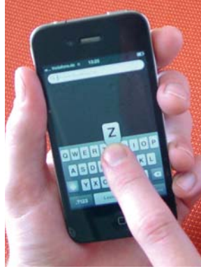
📷 Handy mit elektrotaktilen Feedback (Foto: TU Dresden, Fakultät Elektrotechnik und Informationstechnik)
