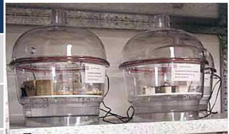
**Abbildung 13:** Kalibrierung mit Exsikkatoren (3 Feuchtigkeitsstufen).
