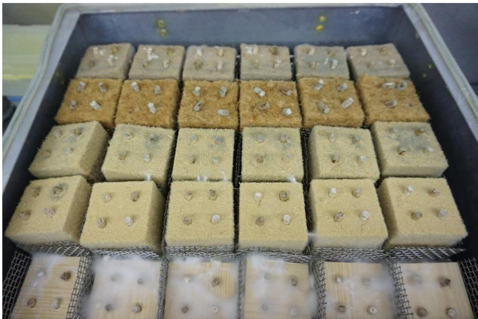
**Abbildung 6: Stärkster Befall der Massivholzprobekörper mit Myzel von holzerstörenden Pilzen (vorne), geringerer Befall der Holzfaserdämmmaterialien.**
