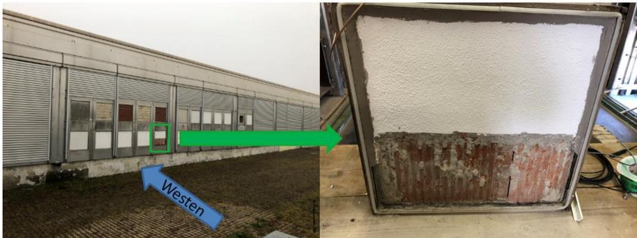
**Abbildung 14:** Einbausituation des Messsystems in der Freilandversuchsstelle am Standort Holzkirchen. Auf der linken Seite ist dabei der Prüfkörper im eingebauten Zustand dargestellt. Auf der rechten Seite der Abbildung ist die Oberflächengestaltung des Prüfkörpers mit dem entfernten Außenputz dargestellt.
