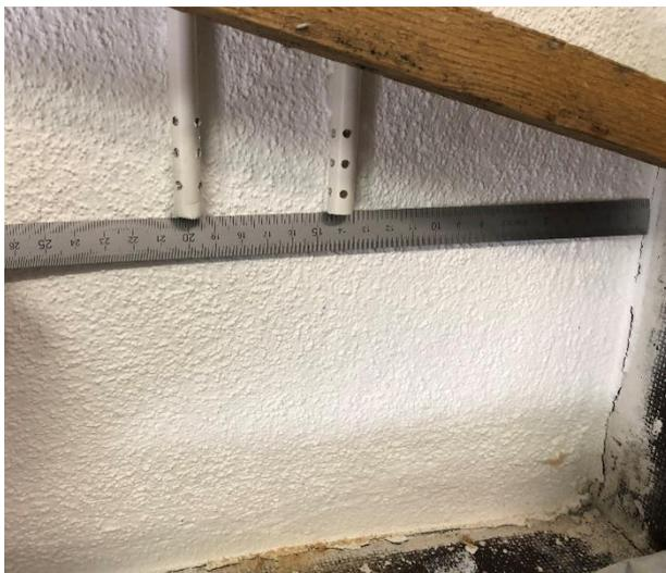
**Abbildung 15:** Kunststoffröhren für den reversiblen Einbau der Sensoren
