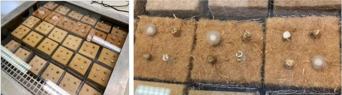
**Abbildung 5: Probekörper in der Inkubationseinheit mit startendem Bewuchs.**
