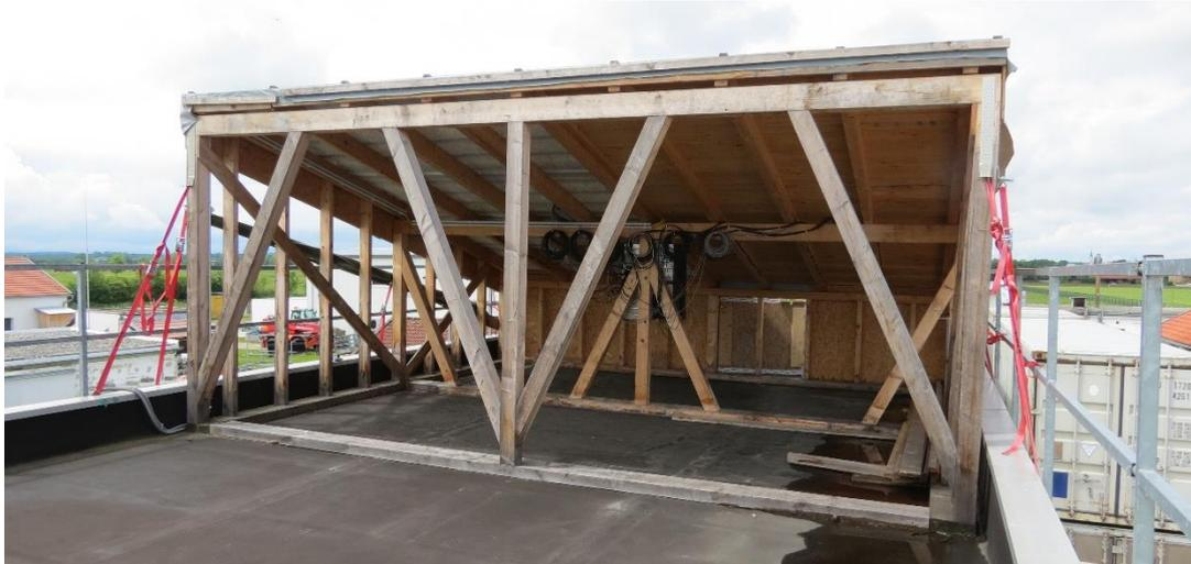
**Abbildung 16: Flachdach Prüfstand an der Freilandversuchsstelle des Fraunhofer IBP am Standort Holzkirchen.**
