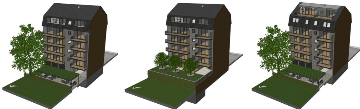
Abbildung 54: von links nach rechts: Entwurf 1 (mit Carport, ohne Penthouse), Entwurf 2 (mit Tiefgarage, ohne Penthouse), Entwurf 3 (mit Carport und Penthouse)
