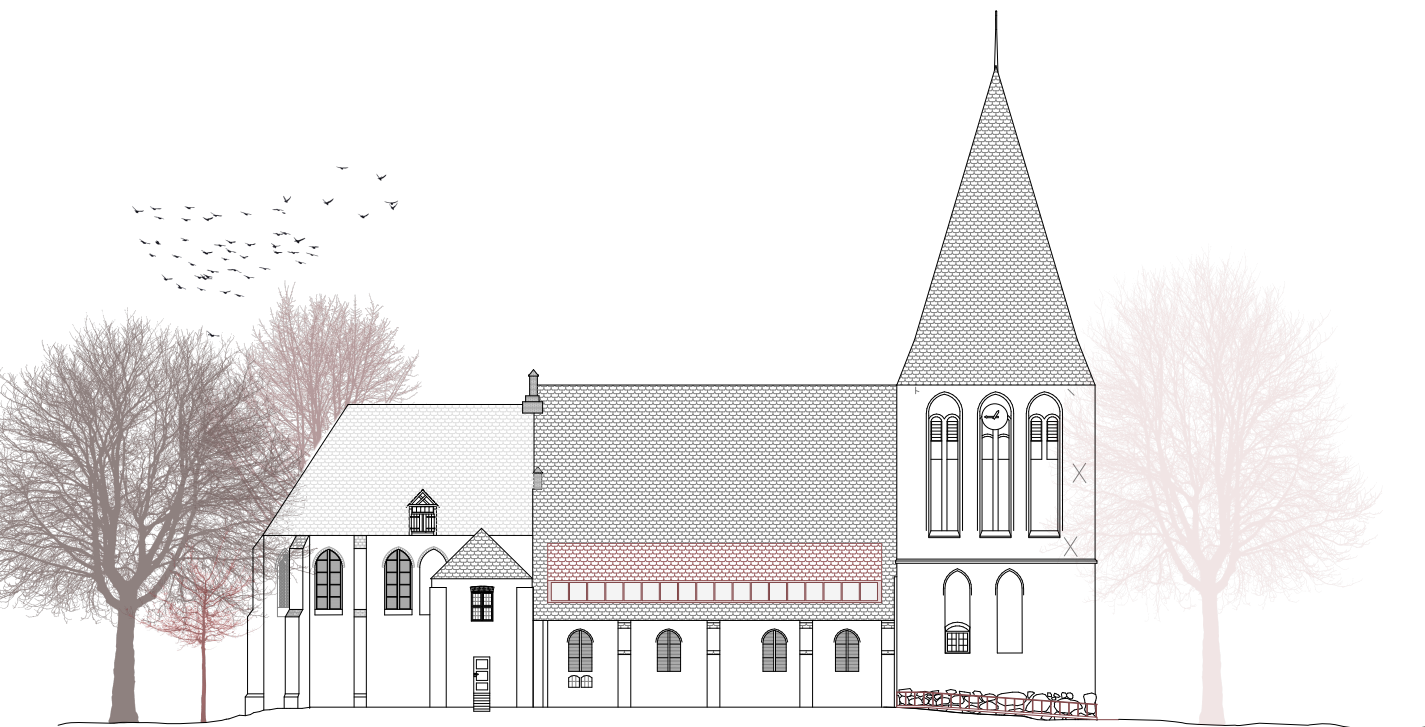
Ansicht Nord mit Stehgaube und barrierefreie Erschließung
