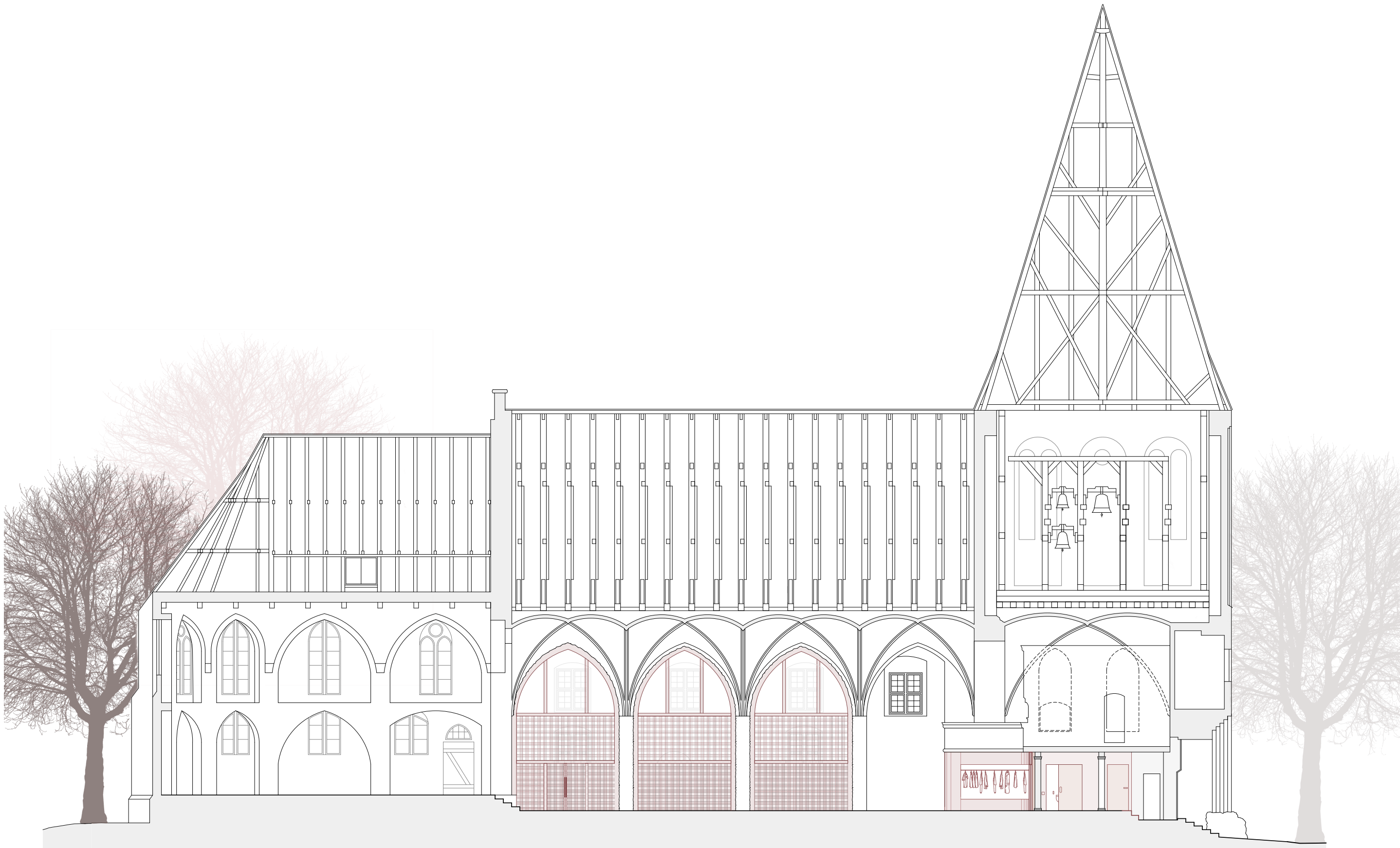
Längsschnitt mit konstruktiver Abtrennung des Südschiffes
