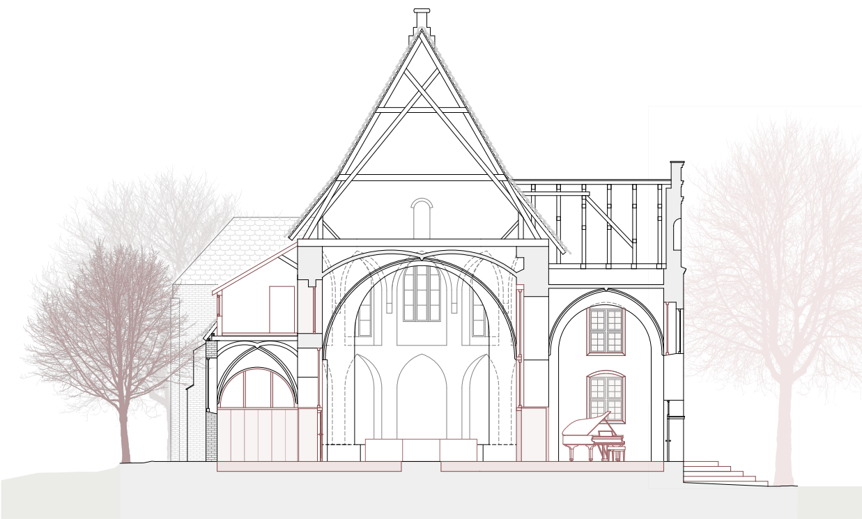
Querschnitt Mittelschiff mit Seitenschiffen Richtung Apsis
