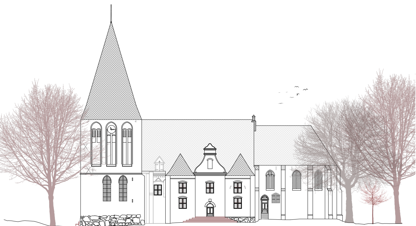
Ansicht Süd mit neuer Aussentreppe
