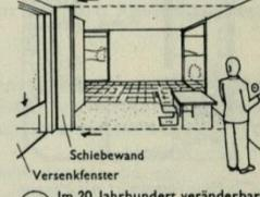
12 Im 20. Jahrhundert veränderbare Räume, elektgetriebene Schiebewände und Versenfenster aus sprossenlosem Spiegelglas, Rollmarkisen als Sonnenschutz
