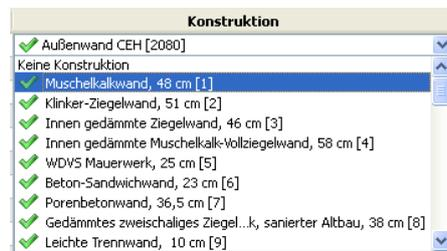
Abb. 2.7: Eingabebereich: Anlegen einer Konstruktion durch Doppelklick auf das Konstruktionsfeld
