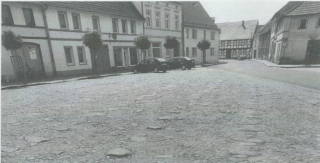
82 Uebigau (Landkreis Elbe-Elster), Marktplatz; Aufnahme 15. 7. 1998. In dem 1825 verlegten Lesesteinpflaster kennzeichneten die erhaltenen Gurtbänder gleichzeitig die Standorte der Marktburden.
