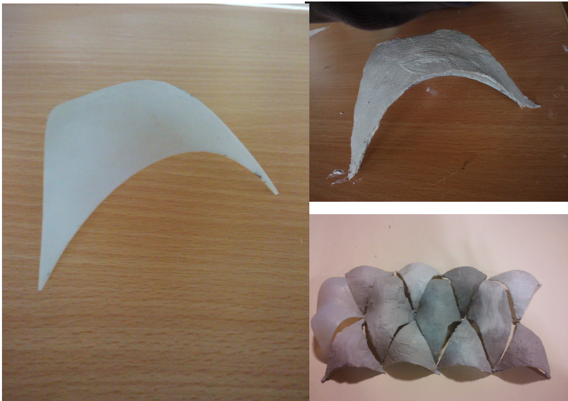
Bild. 10 Links: Fertiges 3D-Druck-Modul. Oben rechts: 3D-Modul als Schablone für Gipsnachbildung. Unten rechts: Fertiges Modell aus Original- und Nachbauteilen. Fig. 10 Left: 3D-print module. Top right: 3D-module as template for a gypsum model. Down right: Final Model.
