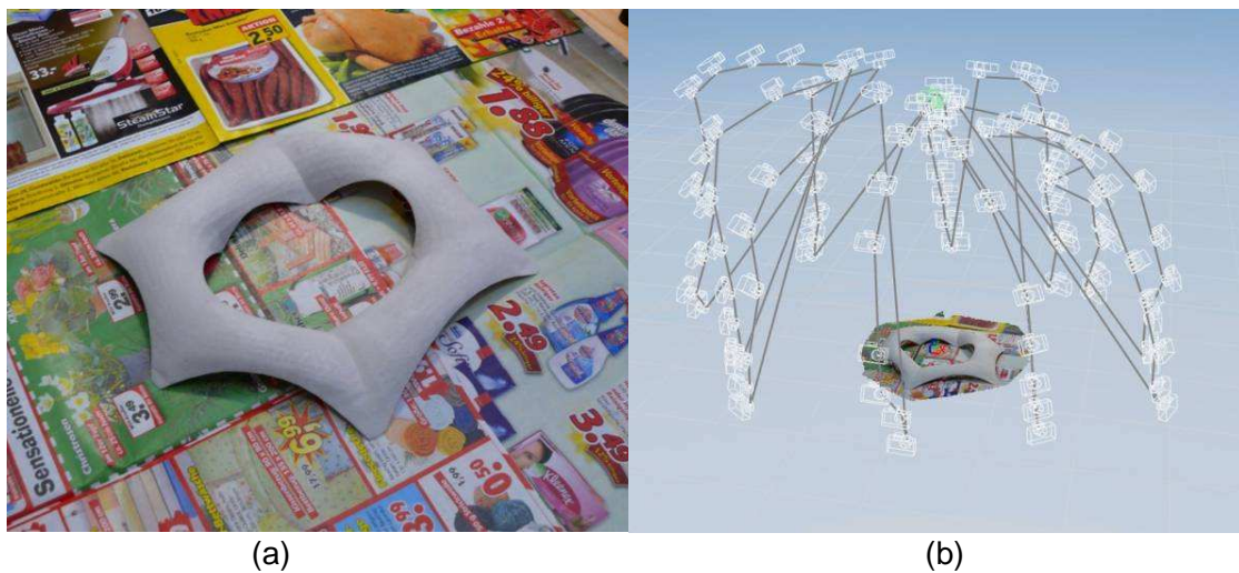
Bild. 13 a) strukturierter Hintergrund für Photogrammetrie b) Kamerapositionen 123D Catch Fig. 13 a) Textured background for the photogrammetry b) Camera positions in 123D Catch
