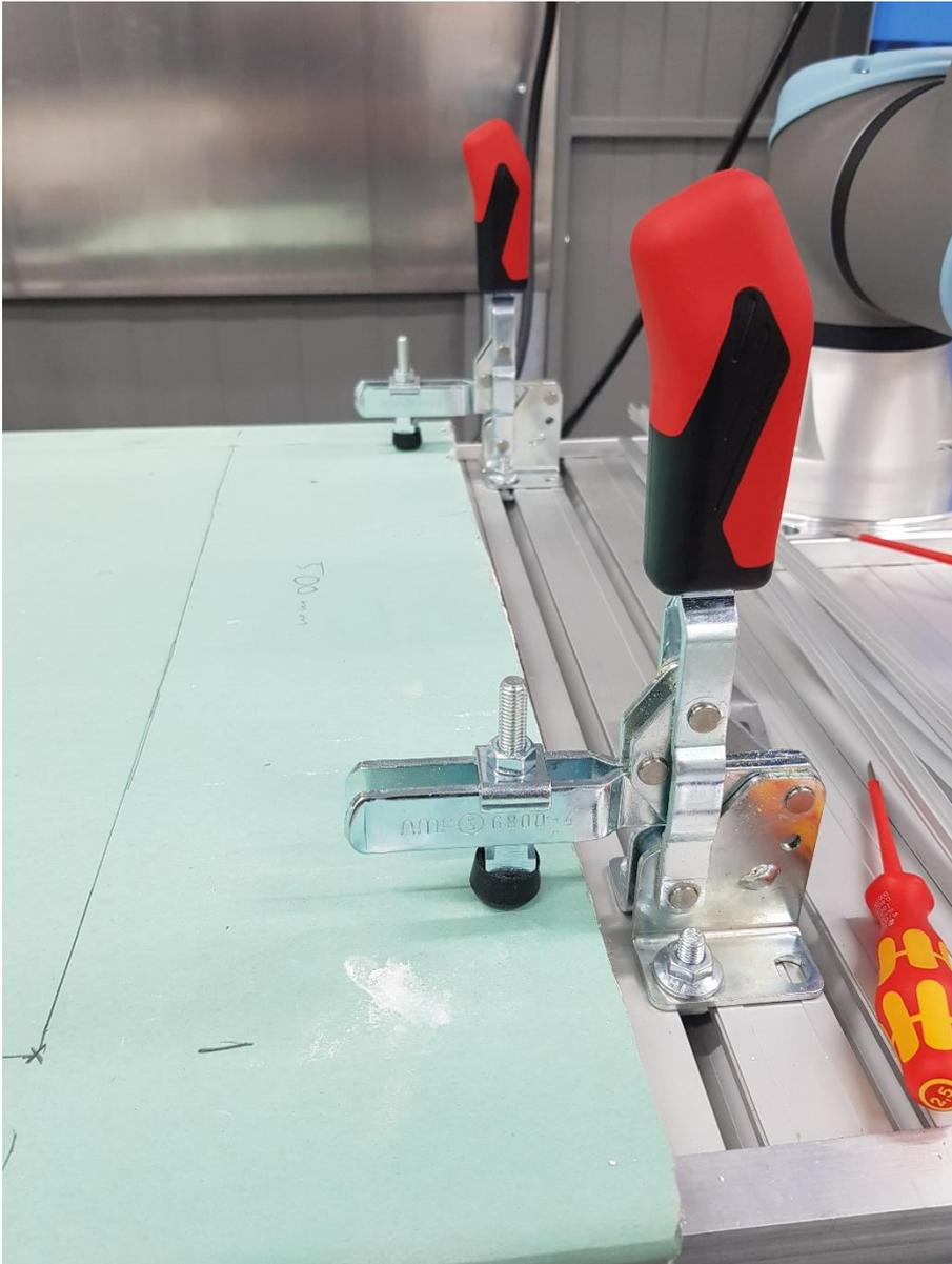
Abb. 31 Einspannung Trockenbauplatte auf Robotertisch<sup>31</sup>
