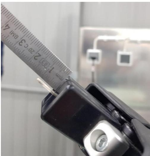
Abb. 32 Modifizierter Robotergreifer für Installation der Arbeitsebene<sup>32</sup>
