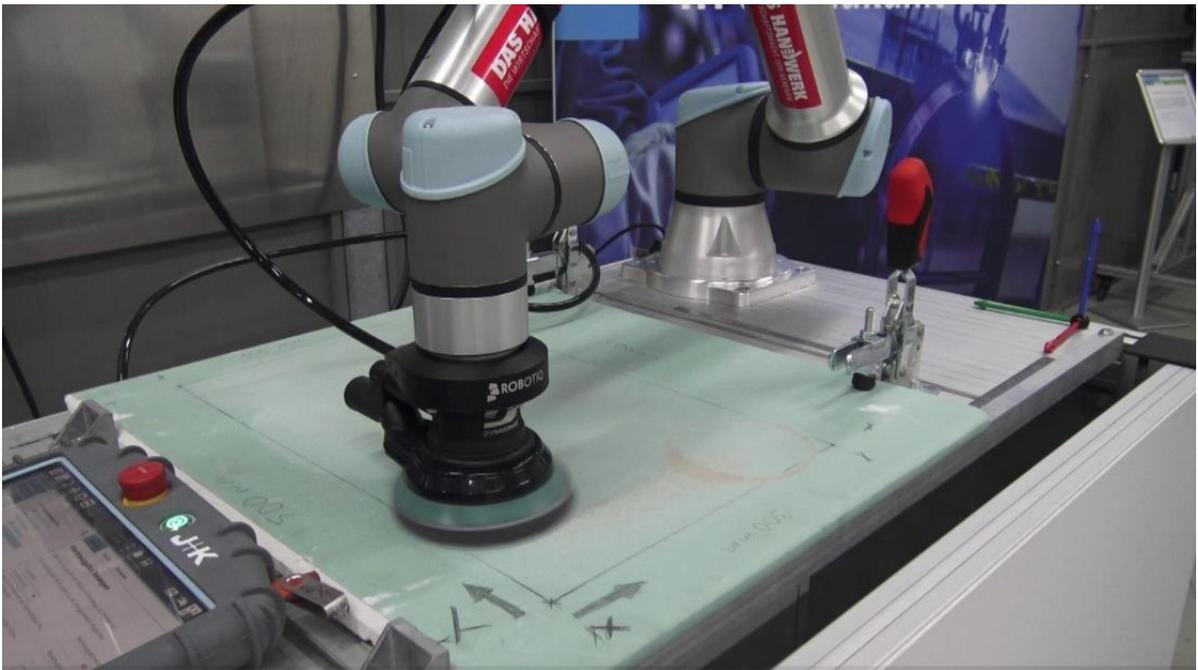
Abb. 39 Robotertest Schleifen der Platte<sup>39</sup>
