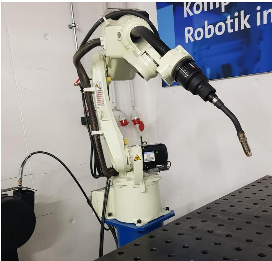
Abb. 21 Schweißwerkzeug an Roboter, HWK Dresden<sup>21</sup>
