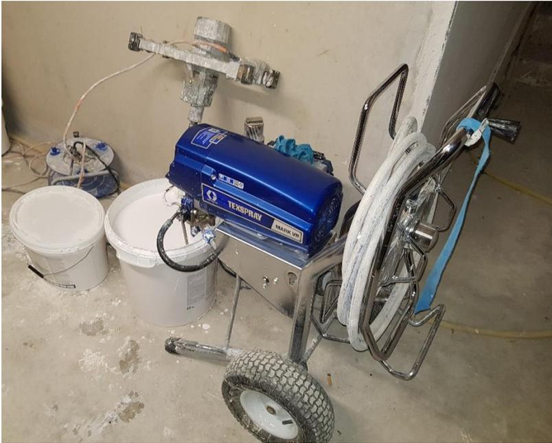
Abb. 6 Airless Gerät für Malerarbeiten, Züblin Baustelle Dessauer Straße in Leipzig<sup>6</sup>
