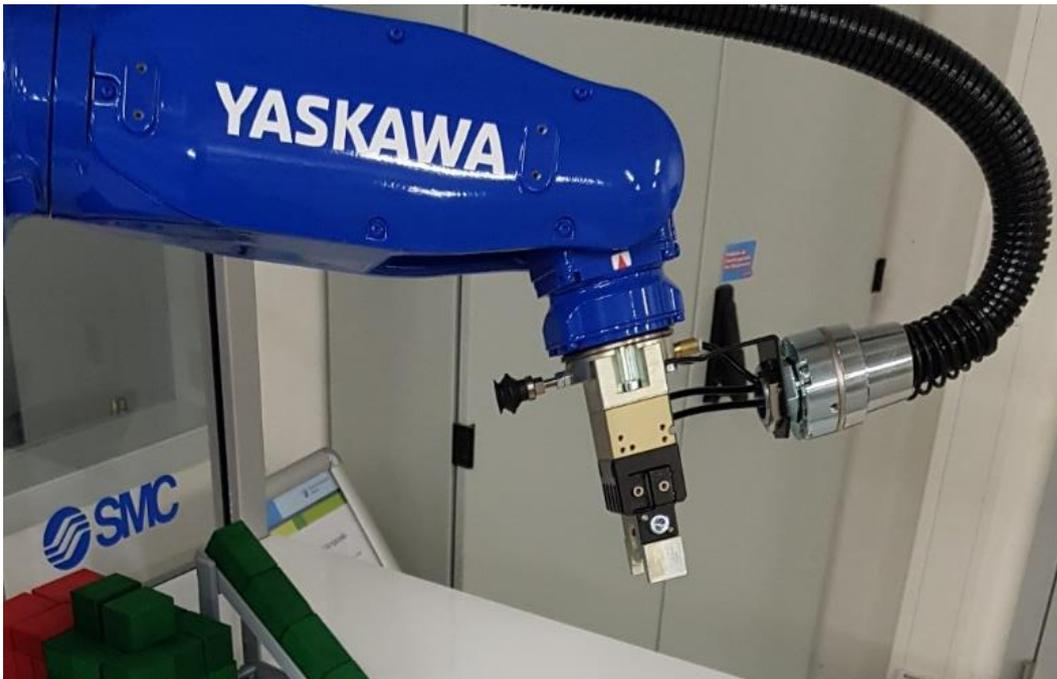
Abb. 20 Yaskawa Roboter mit Kombigreifer, Handwerkskammer Dresden<sup>20</sup>
