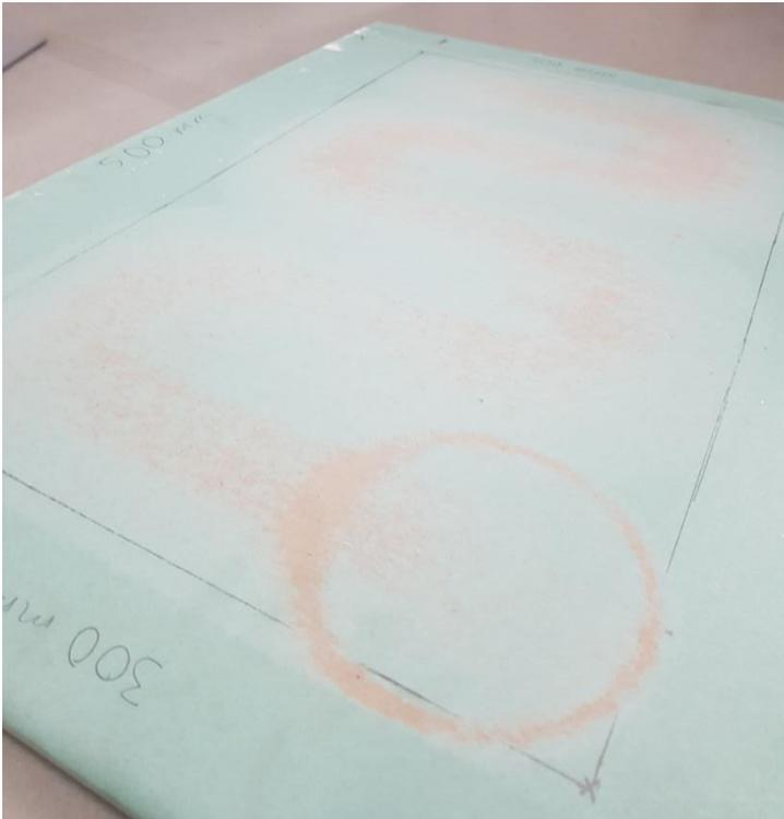
Abb. 45 Beschädigung Trockenbauplatte durch Flächenschleifen<sup>45</sup>.
