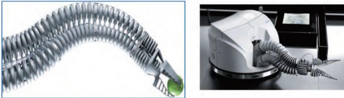
Abbildung 7-1 Roboter mit Elefantenrüssel [67]
