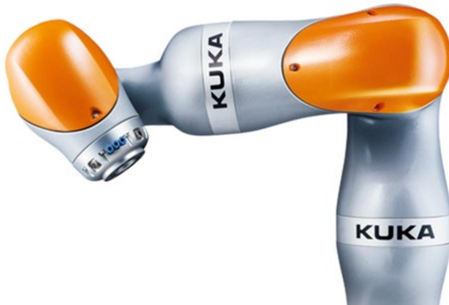
**Abbildung 2-3 KUKA Kollaborativer Roboterarm [12]**
