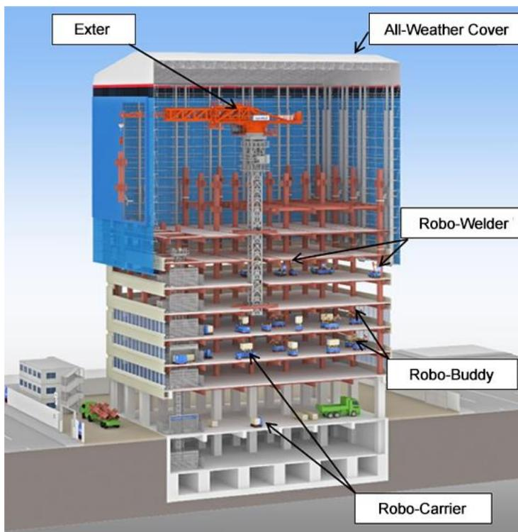
Abbildung 5 Shimizu SMART-System<sup>5</sup>
