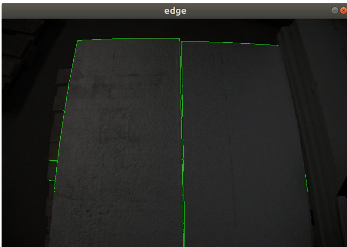
Abb. 4.14 Prüfung der Fugen mit Baufehler
