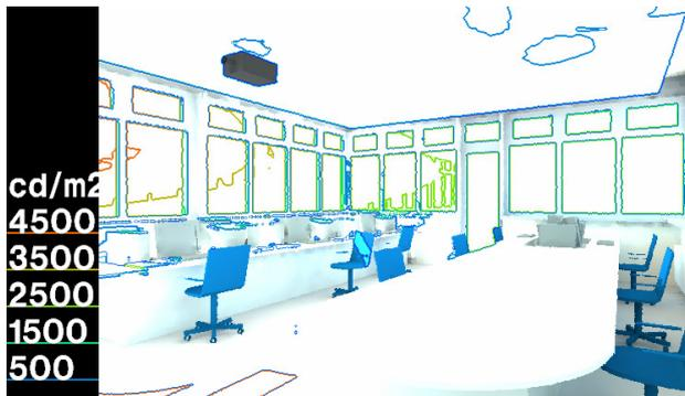
Abbildung 58: Beleuchtungssimulation: ISO-Linien
