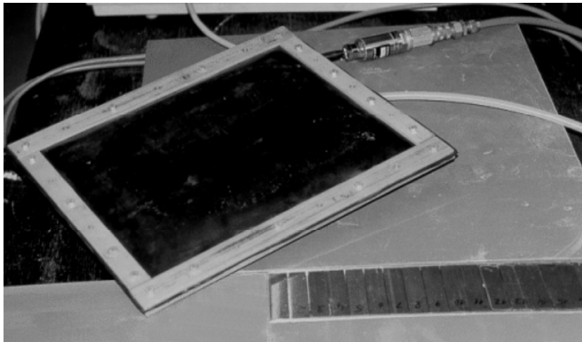
Bild 3.5: Kalibrierung der Erddrucklamellen
