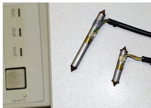
Bild 3.13: Verwendete Aufnehmer für die Messung der Erddruckkräfte
