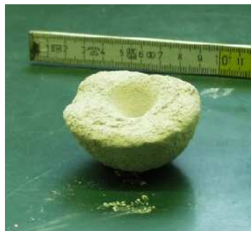
Abbildung 7: Pfropfen aus zerbrochenen Sandkörnern.
