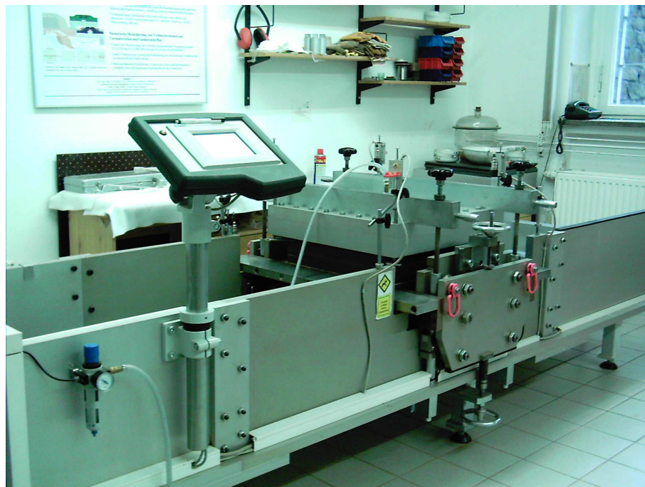
Abbildung 2: Übersicht des Geosynthetik-Boden-Interaktionsprüfgerätes (IPG)
