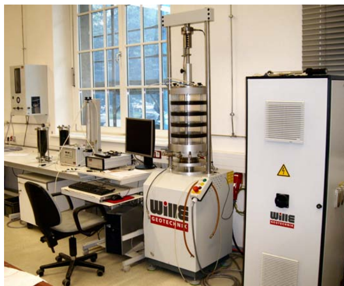
Abbildung 10: Triaxialgerät für statische, zyklische und dynamische Beanspruchungen
