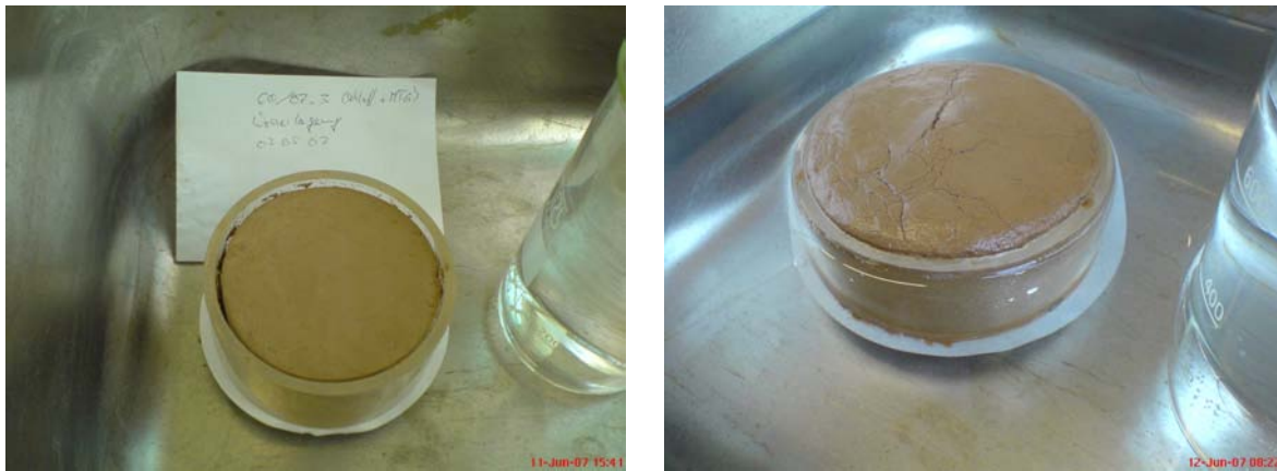
Abbildung 8: Schrumpfen und Schwellen eines leicht- bis mittelplastischen Tons ohne Auflast
