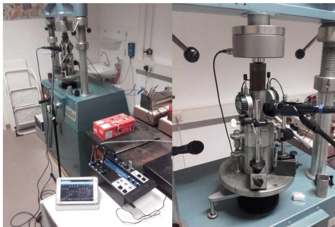
Abb. 2: Ödometerversuche mit akustischer Messung
