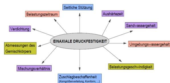
Abb. 4: Zusammenfassung der im einaxialen Druckversuch untersuchten Eigenschaften, rot= starker Einfluss, violett= variabler Einfluss, grün= geringer Einfluss, blau= nicht untersuchter Einfluss
