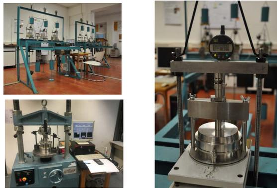
Abb. 3: Ödometergeräte: (12er Stand oben links und rechts, Blaue Presse (d=10 cm) unten links)
