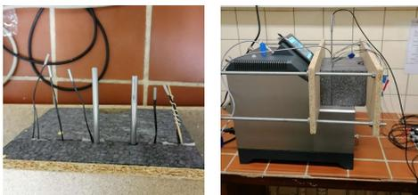
Abb. 2: Kalibrierung der Temperatursensoren
