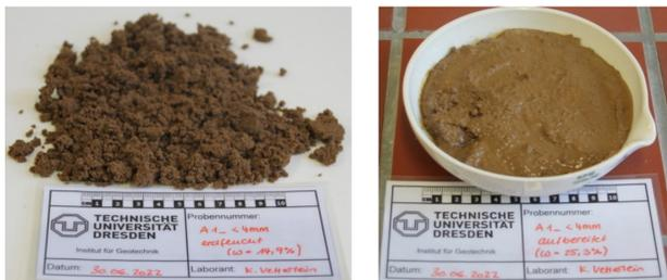
Abb. 1: Erdfeuchtes ( $w = 14,9\%$ ) und aufbereitetes Bodenmaterial ( $w = 25,3\%$ ) mit einem Größtkorn von 4 mm.
