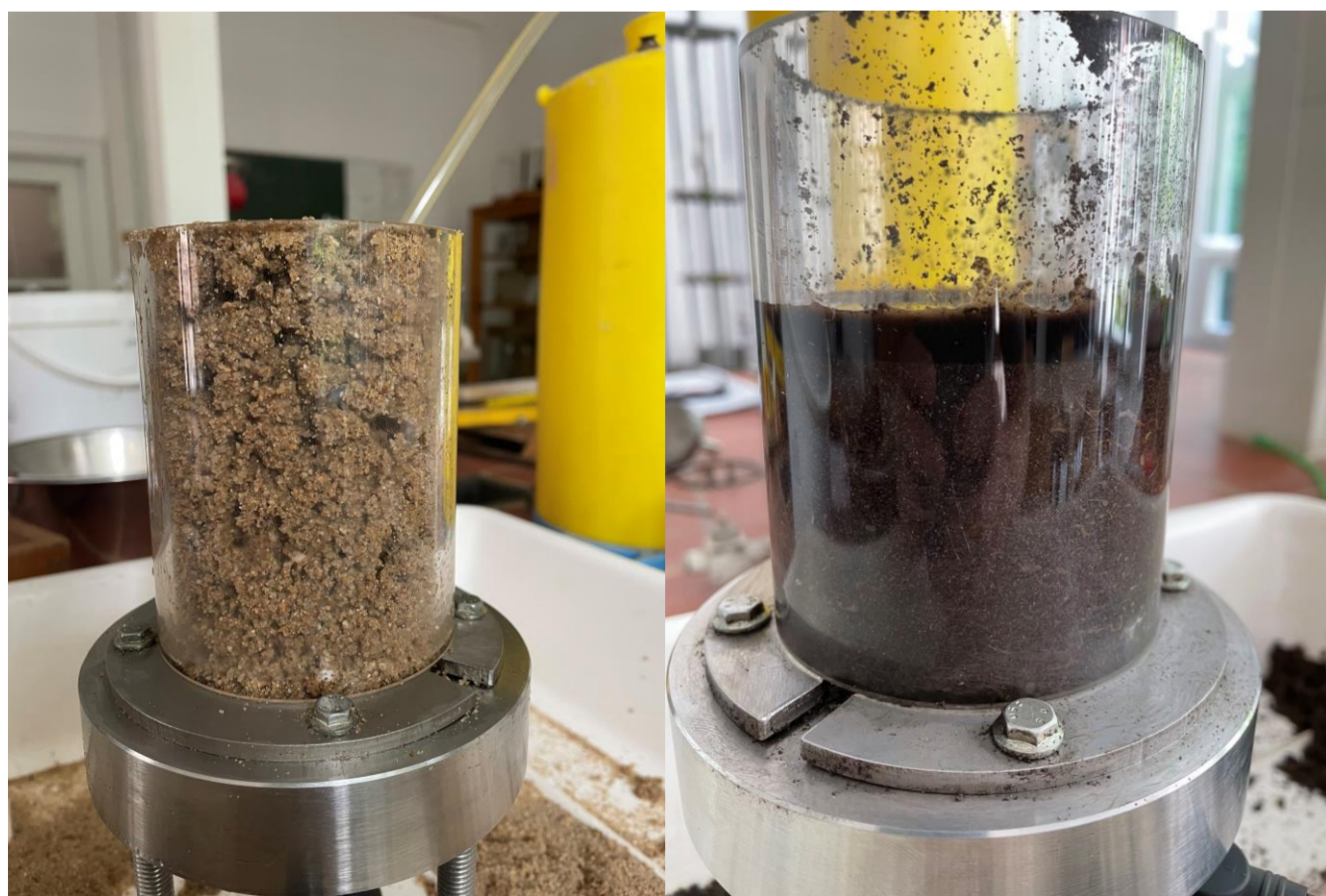
Abb. 1: Probe mit Makroporen nach Siebeinbau (li.) und geflutete, zusammengesackte Probe (re.)
