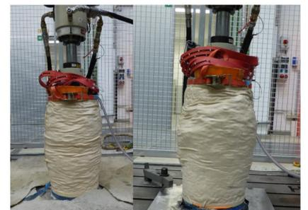
Abb. 6: unbewehrter (links) und bewehrter (rechts) Probestkörper
