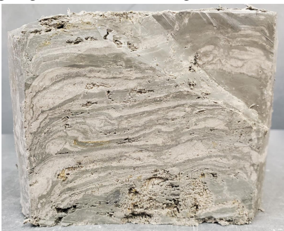
Abb. 2: Schnitt durch eine Bohrprobe (h/b = 10/10 cm), Ton- (dunkel) und Sandlagen (hell) können gut unterschieden werden
