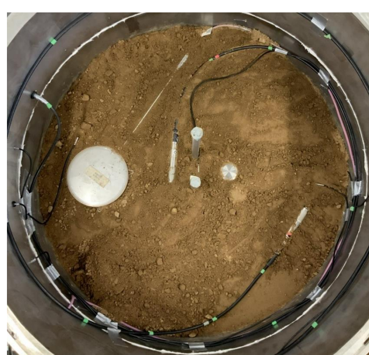
Abb.: Eingebaute Sensoren in der Ebene
