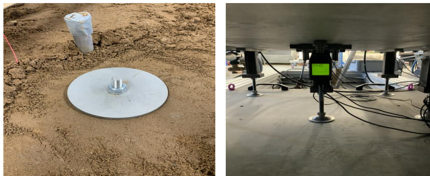
Abb.: Setzungsteller im Versuchsmaterial und Wegaufnehmer unter der Bodenplatte
