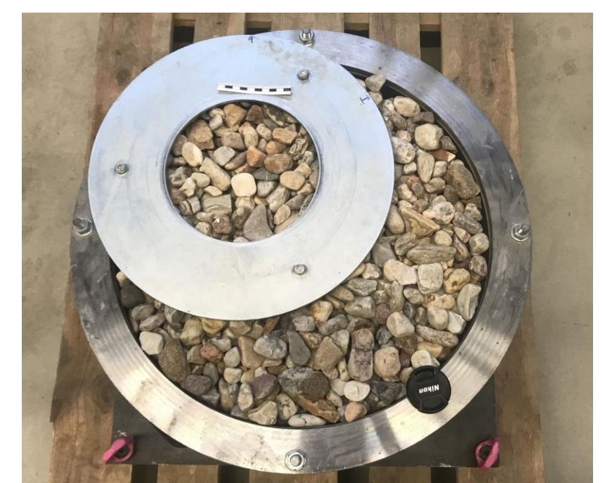
Abb. 5: locker eingebauter Versuchsboden KR in Vorbereitung auf den Prüfgrubenaushub
