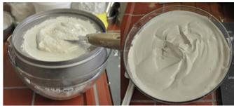
Abb. 2: Sieb mit Größe 0,4 mm (links) und aufbereitete Kreideproben (rechts)
