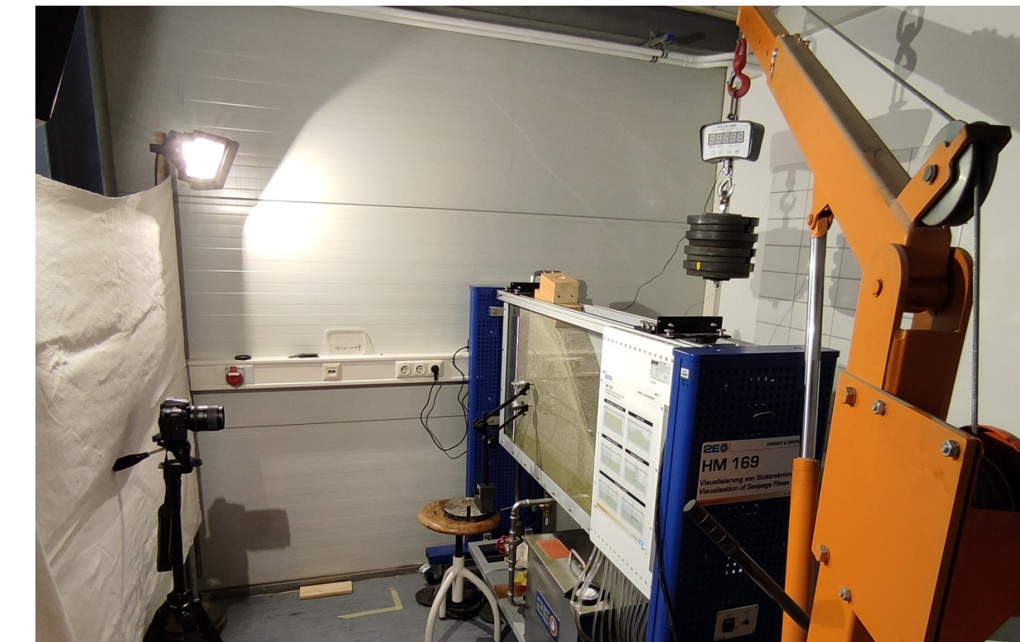
Abb. 4: Versuchsaufbau zur Belastung des Böschungskopfes
