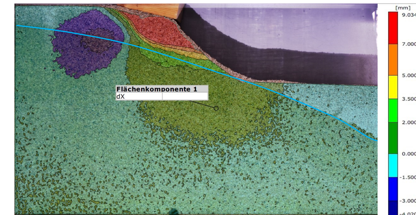
Abb. 5: horizontale Verschiebung (Mod.: „nass“; \alpha = 40^\circ ; Auflast ca. 65 kg; \rho \approx 1,55 \text{ g/cm}^3 )
