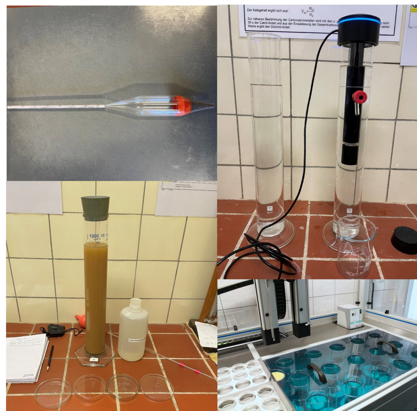
Abb. 2: Aräometer-Birne (o.li.), „PARIQ“-Gerät (o.re.), Pipetten-Verfahren (u.li.), „Sedimat 4-12“ (u.re.)
