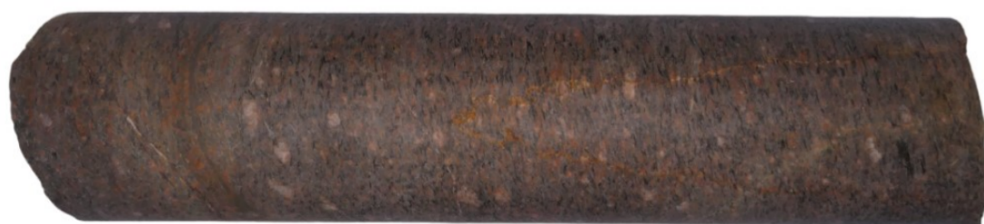
Abb. 2: Rötlichgrauer Gneis „mit Augen“ aus einer Tiefe von 262,38 m unter GOK (d = 10,0 cm, l = 48,6 cm)
