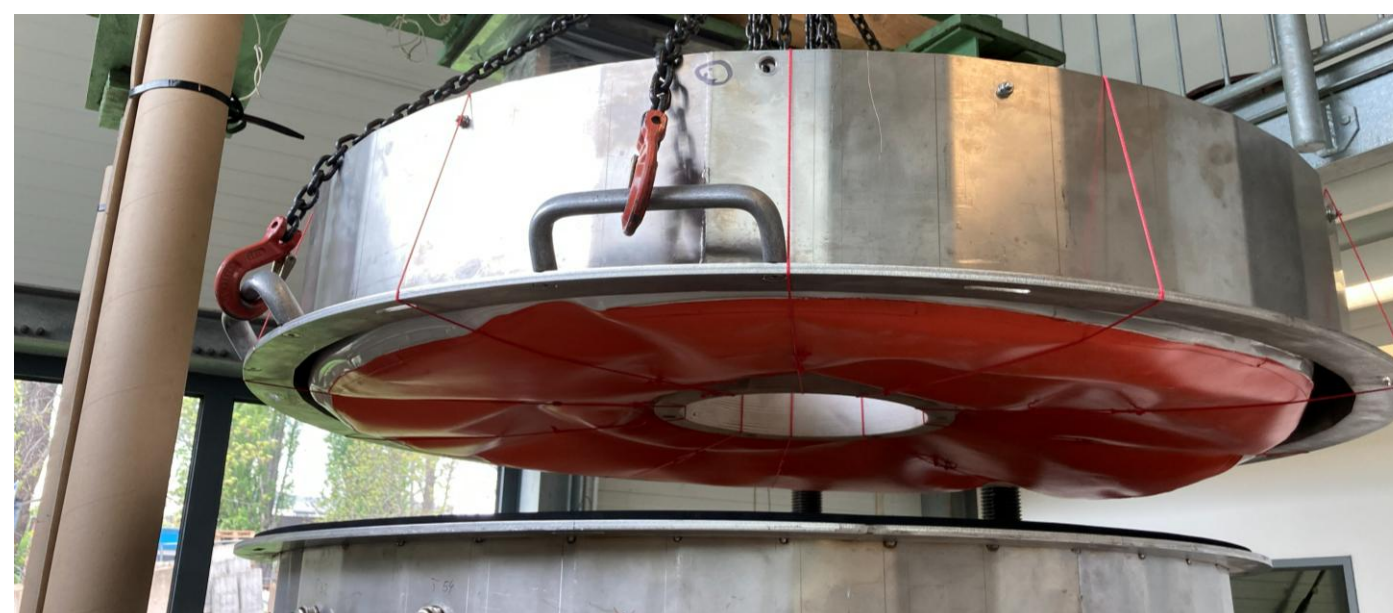
Abb. 1: Belastungsdruckkissen zur Simulation der Straßeneigenlast
