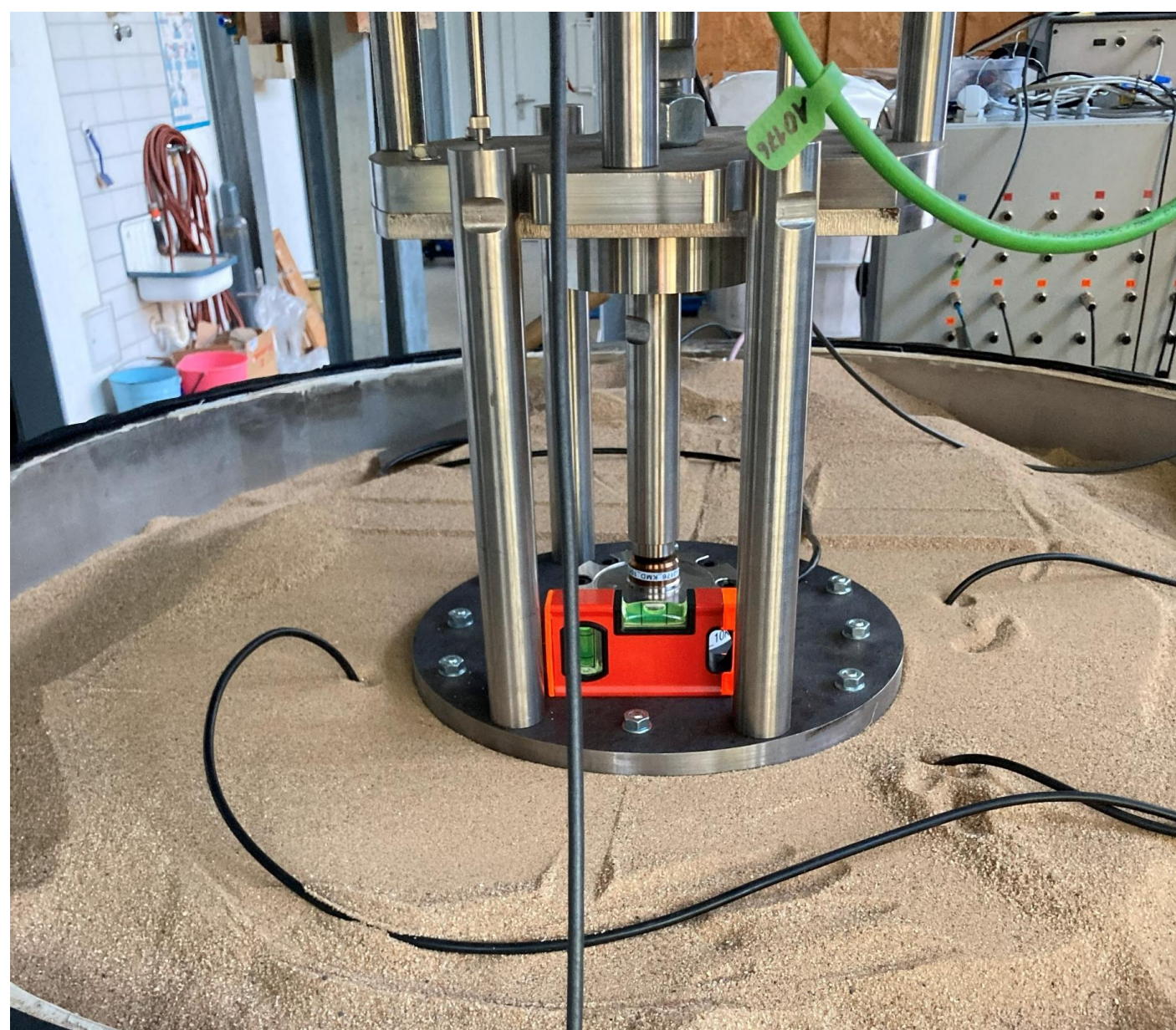
Abb. 2: Linearantrieb zur Simulation der Verkehrslasten hier im Kalibrierprozess der Erddrucksensoren; zusätzliche Erfassung der Setzungen und Temperatur
