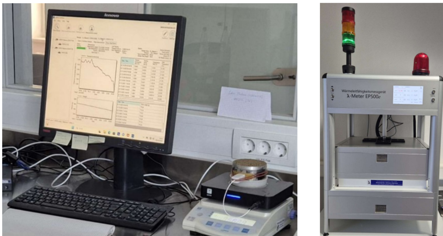
Abb. 1: Messung der Wärmeleitfähigkeit mit der Nadelsonde (links) und mit dem Plattengerät (rechts); Foto: C. Eichholz
