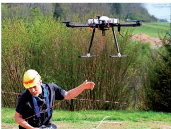
Bild 5 Seiltransport mit unbemanntem Flugsystem
