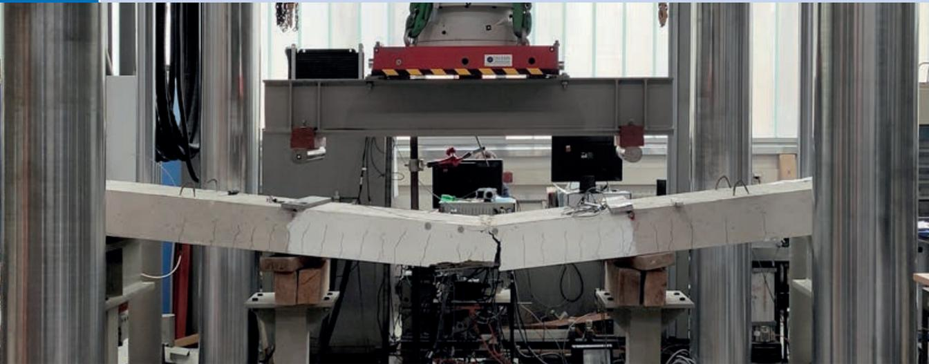
Biegeversuch an einer Platte mit übergreifenden FVK- und Stahlstäben | *Bending test on a plate with overlapping FRP and steel reinforcement* | Photo: Chongjie Kang
