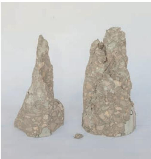
Versagte Betonprobe nach einer zyklischen Belastung | *Concrete specimen after failure due to cyclic loading* | Photo: Stefan Gröschel
