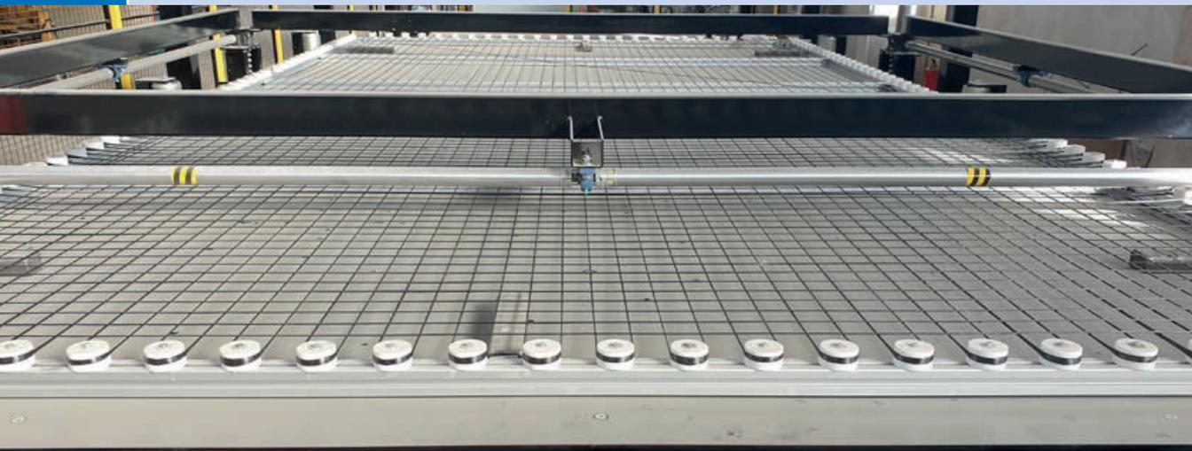
Bewehrungsherstellung im Betonfertigteilwerk | Reinforcement production in the precast concrete plant | Photo: Frank Schladitz
