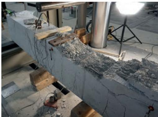
Stahlbetonbalken mit sekundärem Biegedruckversagen | Foto: Daniel Gebauer
