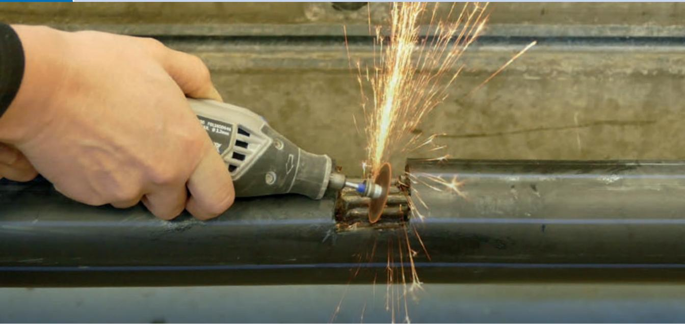
Künstlicher Spanndrahtbruch, erzeugt mit einem Dremel | Artificial wire break using a dremel | Photo: Ronghua Xu
