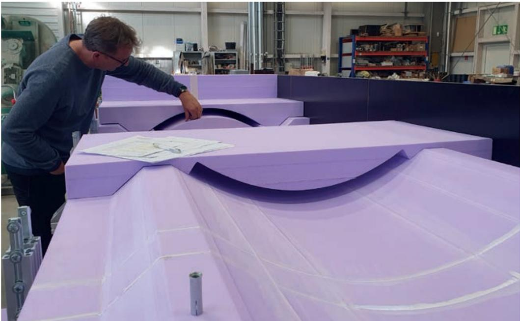
Im OML werden auch Sonderanfertigungen mit hoher Präzision realisiert wie hier die Schalung für eine Carbonbetonschale | *In the OML, special constructions are also realised with high precision – here the formwork for a carbon reinforced concrete shell* | Photo: Silke Scheerer
