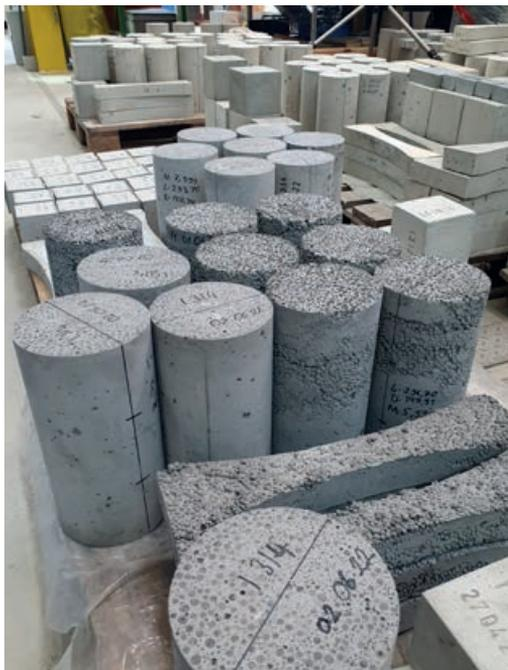
Proben aus verschiedenen Betonen mit unterschiedlichen Geometrien für die Bestimmung von Materialkennwerten | *Samples from a variety of concretes with different geometries for the determination of material properties* | Photo: Silke Scheerer
