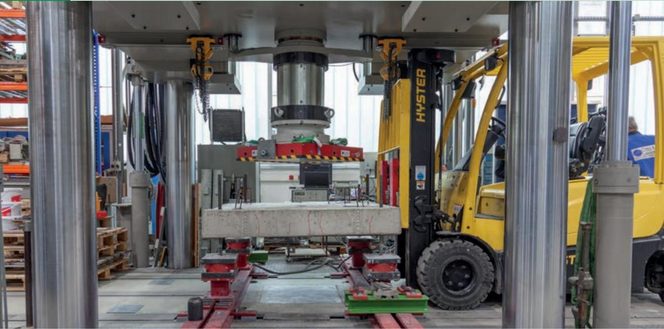
Vorbereitung eines Resttragfähigkeitstests | Preparation of a test to determine the residual load-bearing capacity | Photo: Stefan Gröschel
