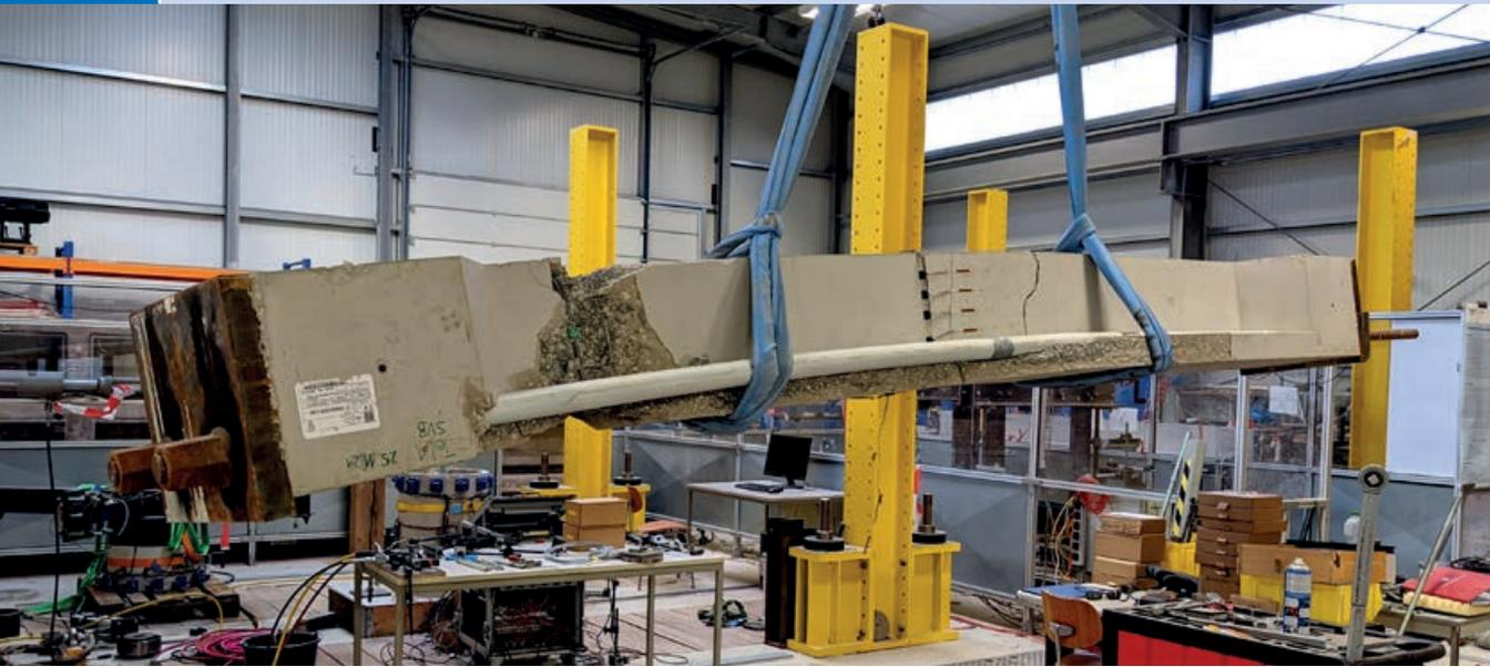
Ausgebauter und beschädigter Balkenprobekörper | Dismantled and damaged beam specimen | Photo: Dennis Birkner
