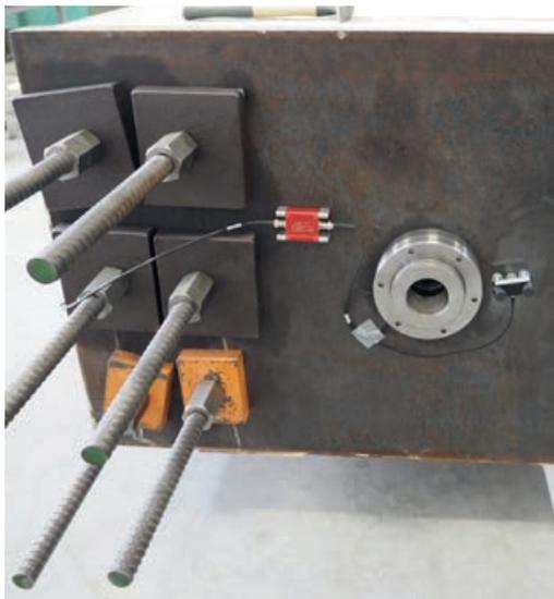
Ein piezoelektrischer Sensor und ein Vorverstärker am Ende eines Spannglieds | A piezoelectric sensor and a preamplifier at the end of a tendon | Photo: Ronghua Xu
