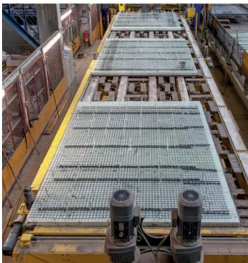
Fertigung von Doppelwänden mit nichtmetallischer Bewehrung | Fabrication of double walls with non-metallic reinforcement | Photo: Stefan Gröschel
