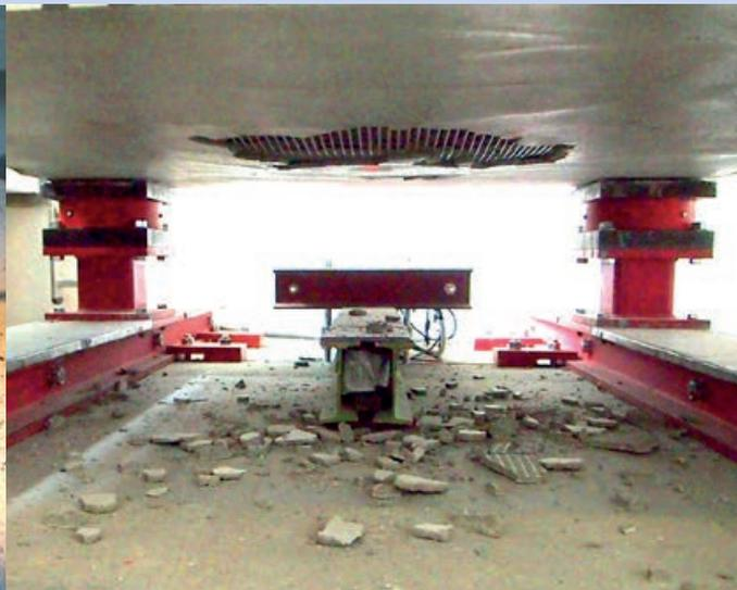
Oberseite (links) und Unterseite (rechts) einer im Fallturm getesteten Platte | Top (left) and rear side (right) of a tested plate in the drop-tower | Photos: Franz Bracklow
