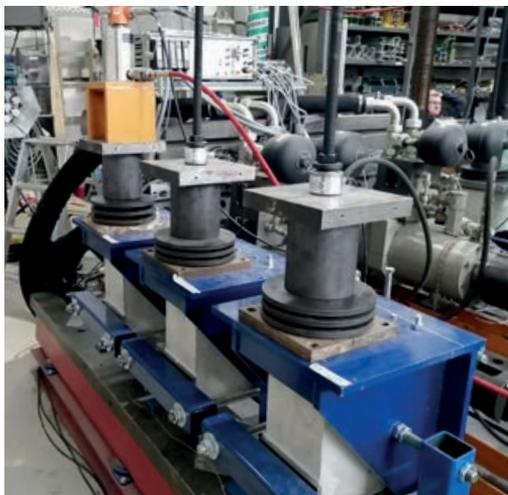
Balkenendprobekörper unter Dauerbelastung | *Beam-end specimens under sustained loading* | Photo: Marc Koschemann
