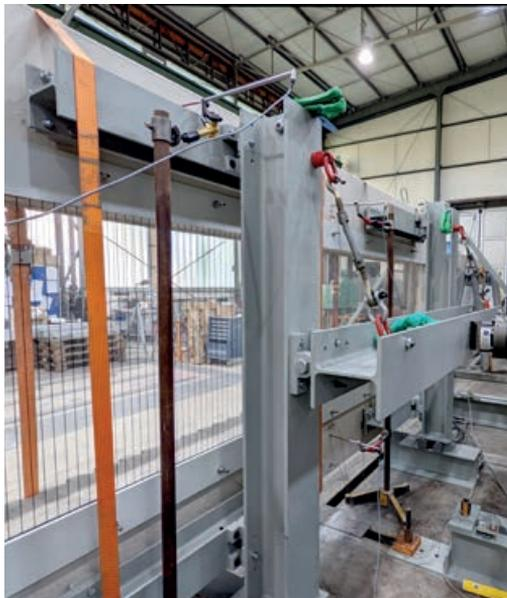
Lastverteilungskonstruktion des statischen Versuchs auf der Rückseite des Wandelements | Load distribution construction for the static test on the rear side of the element | Photo: Dennis Birkner
