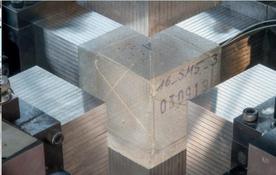
Triaxialprüfmaschine (links) und Betonwürfel mit faseroptischem Sensor umgeben von Belastungsbürsten (rechts) | Triaxial testing machine (left) and concrete cubic with embedded fiber optic sensor surrounded by load introduction brushes (right) | Photos: Stefan Gröschel
