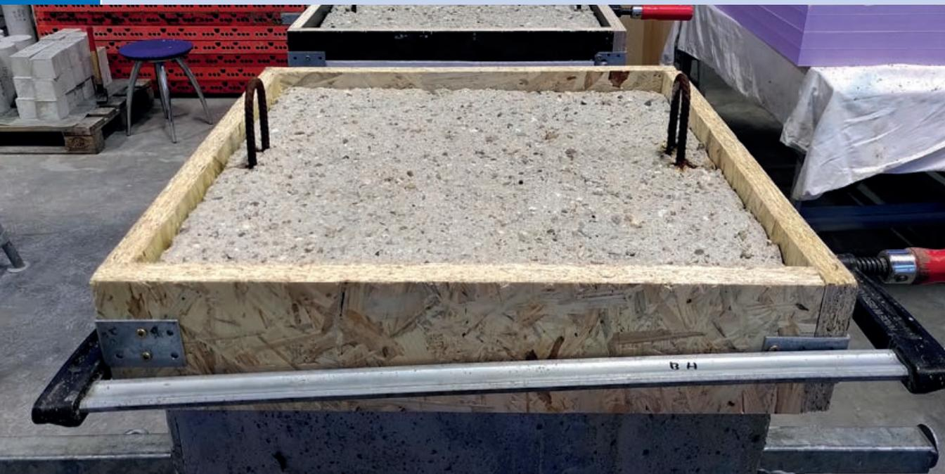
Stahlbetonquader vor dem Aufbringen einer Dämpfungsschicht | Steel reinforced concrete block before damping layer application | Photo: Lena Leicht
