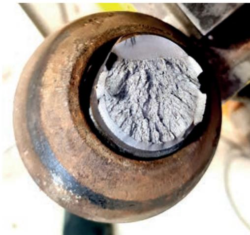
Detailaufnahme eines ungeplanten Ermüdungsbruchs in einem Gewindestab | Detailed view of an unexpected fatigue failure of a threaded rod | Photo: Olaf Menze
