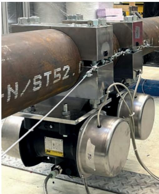
Mittig angeordnete Unwuchtmotoren bei Demonstrator II | *Centered unbalanced motors at Demonstrator II* | Photo: René Wallschläger
