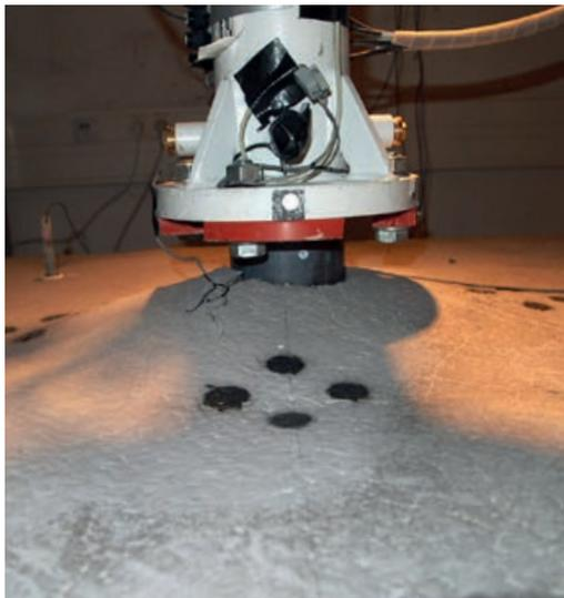
Aufwölbung der Dämpfungsschicht nach einem Beschussversuch einer Platte mit 220 km/h | *Bulging of the damping layer after an impact test of a plate at 220 km/h* | Photo: Lena Leicht
