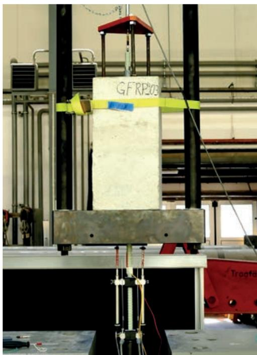
Ausziehversuch mit langer Verbundlänge | *Pull-out test with long bond length* | Photo: Chongjie Kang
