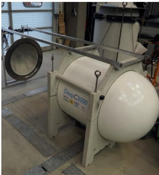
Geöffnetes DeepC3000-Gehäuse mit Deckelverschiebeeinheit im Otto-Mohr-Laboratorium | *Open DeepC3000 housing with cap sliding unit in the Otto Mohr Laboratory* | Photo: Marcus Hering
