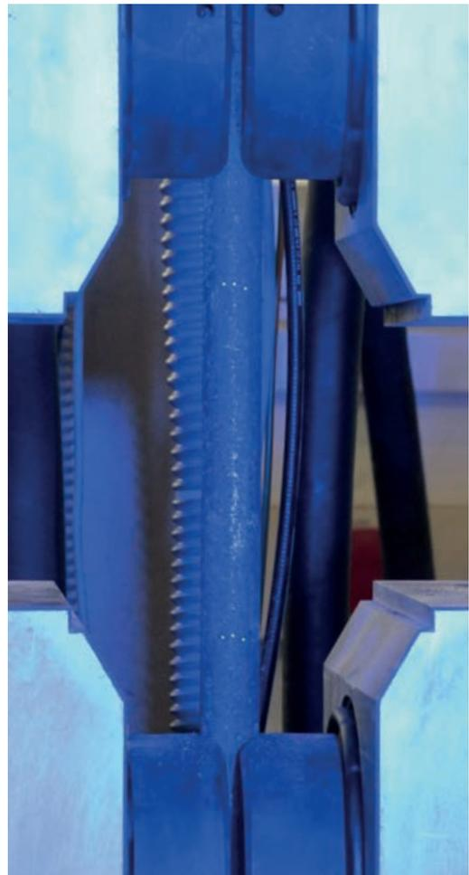
Zugversuch an einem historischen Bewehrungsstahl | *Tensile test on a historic steel reinforcement bar* | Photo: Sabine Wellner
