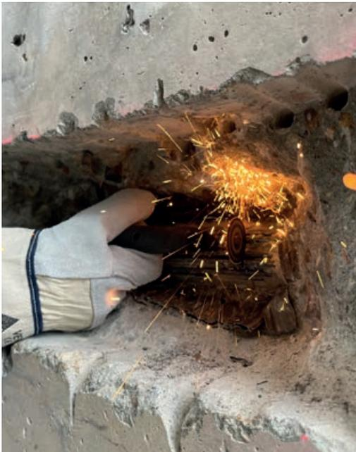
Gezielte Schädigung einzelner Spanndrähte | *Planned damage of single tension wires* | Photo: Max Herbers
