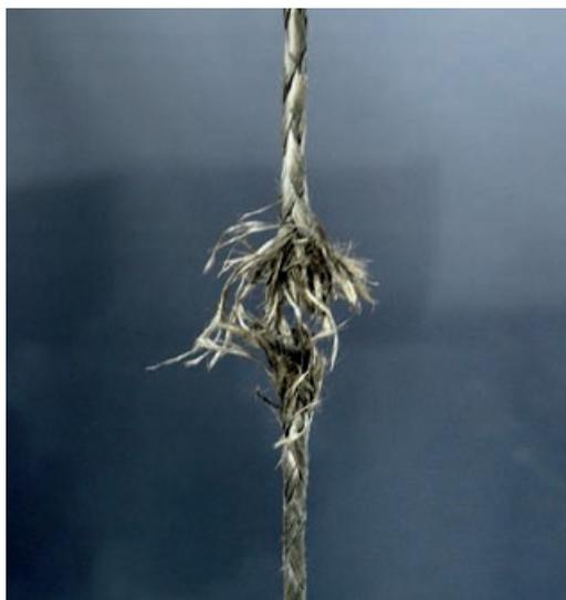
Zerstörter formbarer Carbonfaser-Flechtstab der Johne & Groß GmbH nach erfolgreicher Zugprüfung | *Destroyed braided rod from Johne & Groß GmbH after successful tensile test* | Photo: Berk Gündogdu
