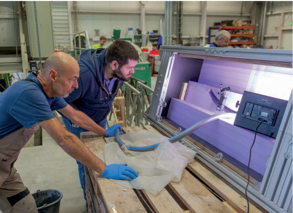
Die Herstellung komplizierter Bauteile wie hier einer Carbonbetonschale ist nur im Team möglich | *The concreting of complex components, such as here a carbon reinforced concrete shell, is only possible in the team* | Photo: Stefan Gröschel
