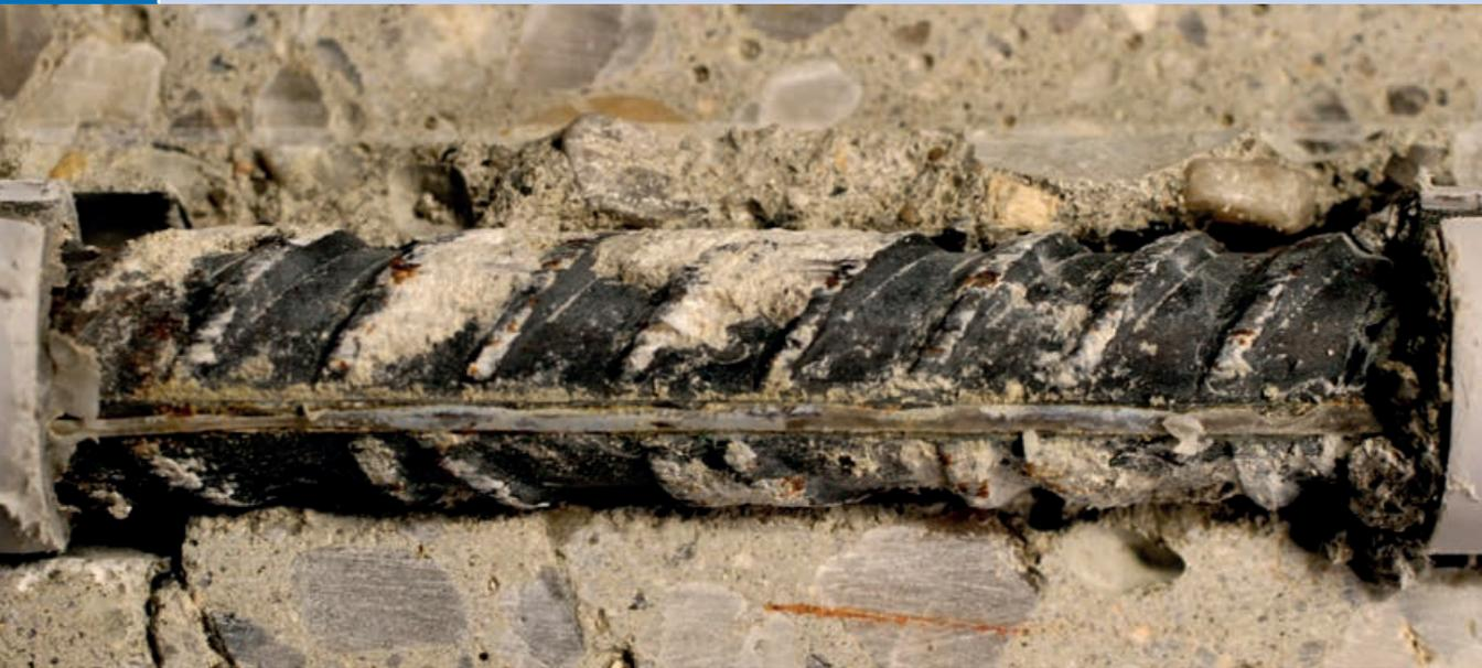
Verbundzone mit faseroptischem Sensor nach Versagen | Bond zone with fiber-optic sensor after failure | Photo: Marc Koschemann
