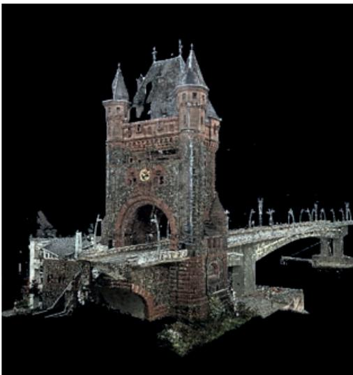
Die 3D-Punktwolke der Nibelungenbrücke Worms, erzeugt durch Laserscanning | 3D point cloud of the Nibelungen bridge in Worms generated by laser scanning | Graphic: Christian Hesse (Dr. Hesse und Partner Ingenieure)
