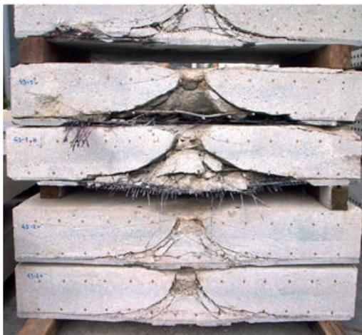
Querschnitte unterschiedlich getesteter Platten mit Verstärkungsschicht | Cross sections of different tested plates with strengthening layer | Photo: Franz Bracklow
